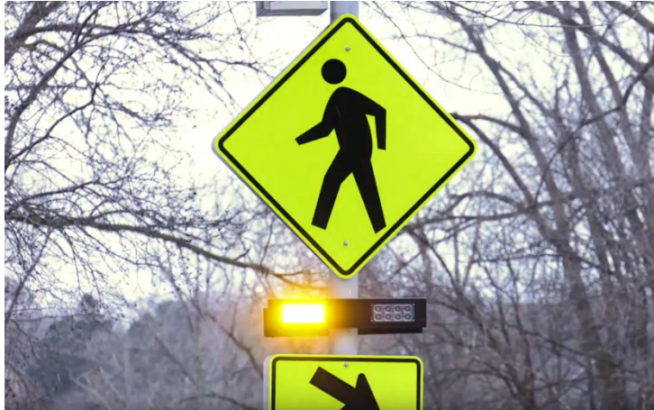
Abb. 15 Blinkendes Warnlicht für Fahrzeuglenkende auf Anmeldung durch Zufussgehende beim Queren
