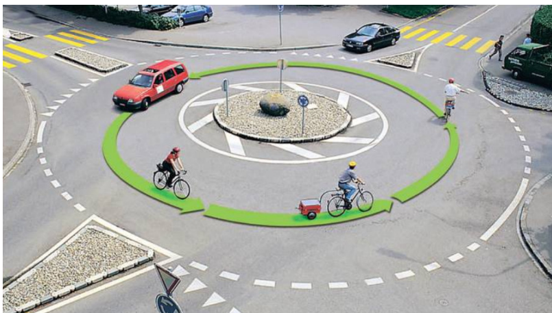
Abb. 17 Linienführung für Velofahrende im Kreisverkehr kennzeichnen
