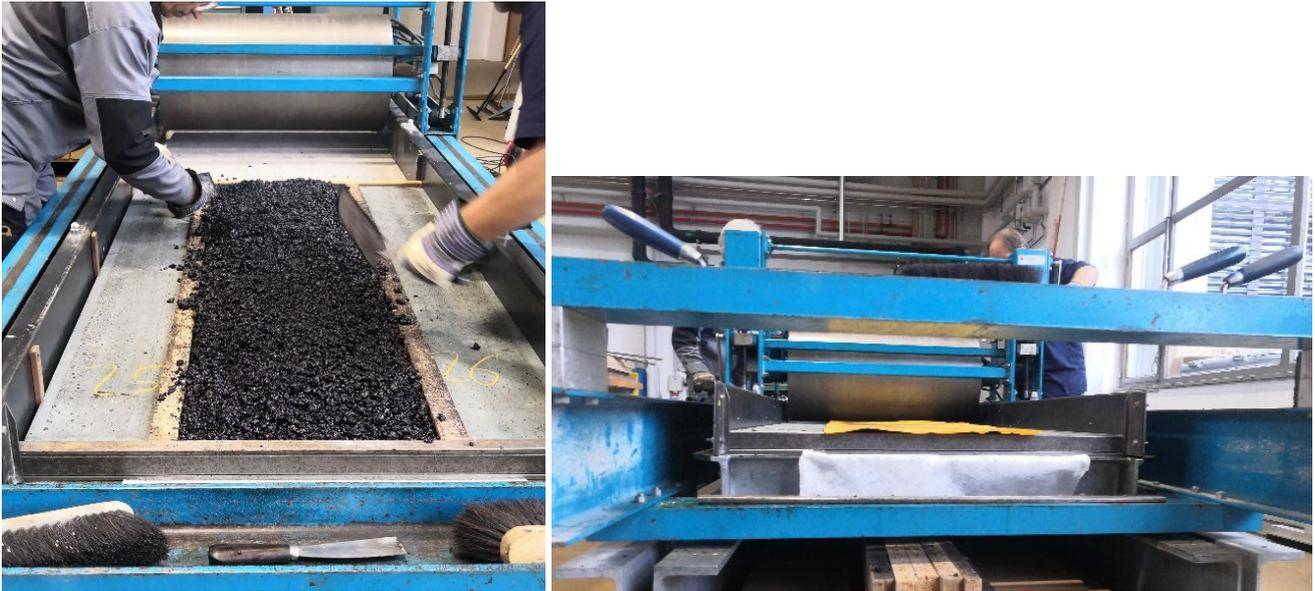
Abbildung 50. Mischgut wird in die Form gefüllt (links) und verdichtet (rechts)
