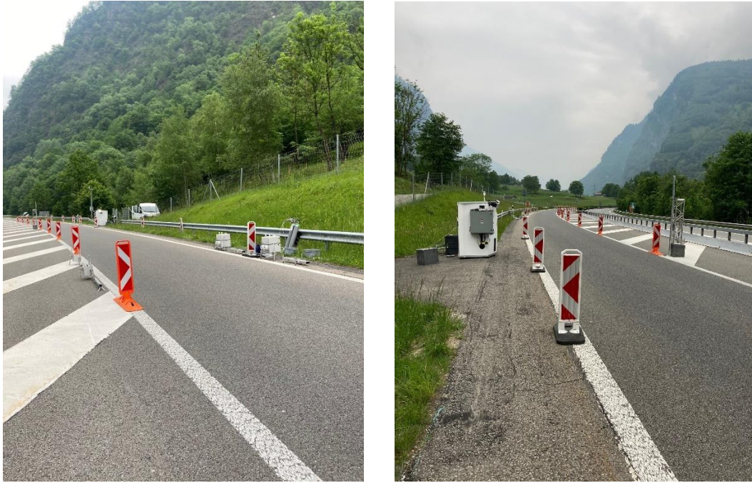
Abb. 4 Überblick der aufgebauten Messgeräte. Links: Im Vordergrund die beiden Systeme OPUS RSD 5500 #1 und #2 und im Hintergrund das seitliche Messsystem EDAR 2 in der Service-Nische. Rechts das seitliche Messsystem EDAR 2 mit Blick auf den Spurführungsverlauf.
