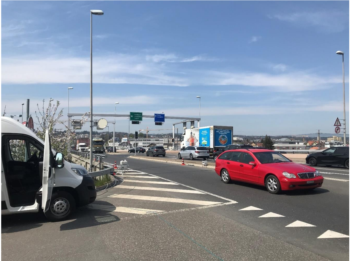
Abb. 12 Standort Sedel (SED) mit dem OPUS RSD 5500 #1 in der Bildmitte, Sicherheitspilonen und dem Messtechnikerfahrzeug mit Kalibriergasleitungen hin zum Messgerät rechts.
