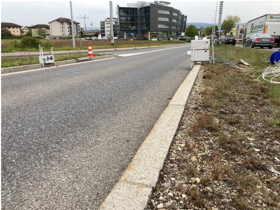
Abb. 17 Standortaufnahme in Sursee (SUR) mit dem OPUS RSD 5500 #1-Messgerät. Links der Fahrbahn der Reflektor und rechts die Messeinheit und Kamera zur Kennzeichenerfassung im Hintergrund.
