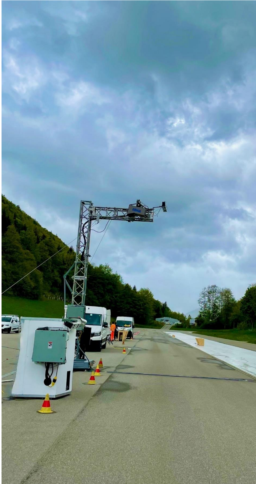
Abb. 20 Überblick über den Geräteaufbau auf der Teststrecke in Vauffelin (VAU). Von vorne nach hinten betrachtet folgen die beiden HEAT Messsysteme EDAR 1 (seitlich) und EDAR 2 (über Kopf) gefolgt vom Messgerät der TU Graz und den beiden Messsystemen OPUS RSD 5500 #1 und #2 mit den Wetterschutzgehäusen. Trockene Fahrbahnverhältnisse waren selten.
