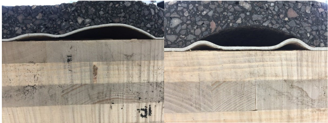
Abbildung 45 : Schnittbilder der spontanen Blasenbildung während des Einbaus des Gussasphaltes; System 2e (Platte P9 ; BSP / PMMA-Versiegelung / PMMA-Abdichtung / MA 8 25 mm bei 190°C)
