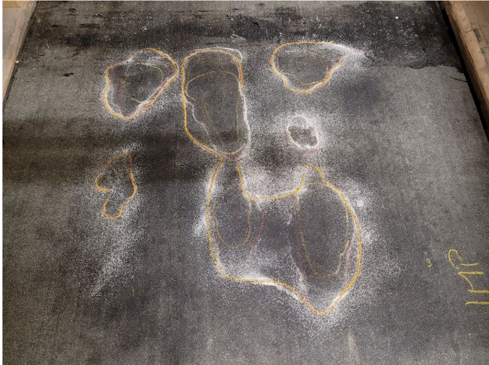
Abbildung 48 : Blasen auf der Abdichtung nach einer 8 Temperaturzyklen
