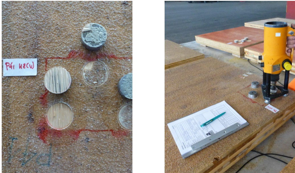
Abbildung 32: Durchführung der Haftzugversuche mit Stempeln ( \varnothing 50 mm)
