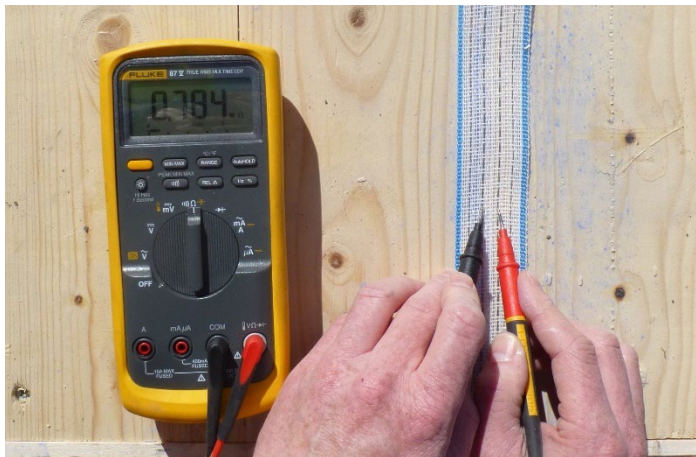
Abbildung 76: Einbaukontrolle der Sensorbänder mit Multimeter
