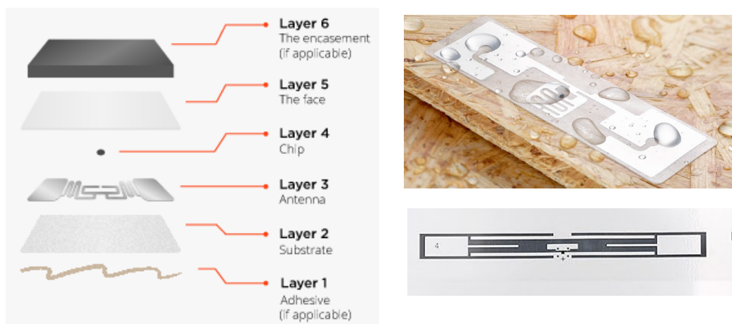
Abbildung 57: Komponenten eines RFID-Tags (Smiley S. 2019) (links)
