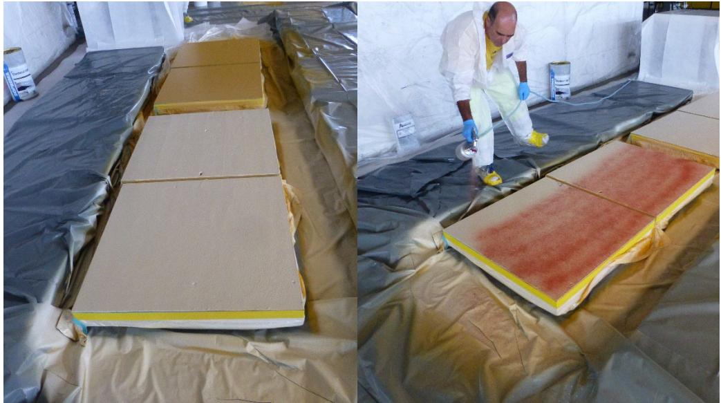
Abbildung 10 : Aufbringen des Part A und Part B (links) auf der Part 1 Lage und das Aufbringen der Tack Coat (rechts)
