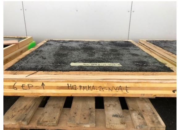
Abbildung 44 : Platten (BSP) mit PMMA-Abdichtung nach dem Einbau des MA ; links Platte 3 (PMMA-Abdichtung ; MA 11 40 mm ; 230 °C); rechts Platte 6 (PMMA-Abdichtung; MA 8 25 mm; 190 °C
