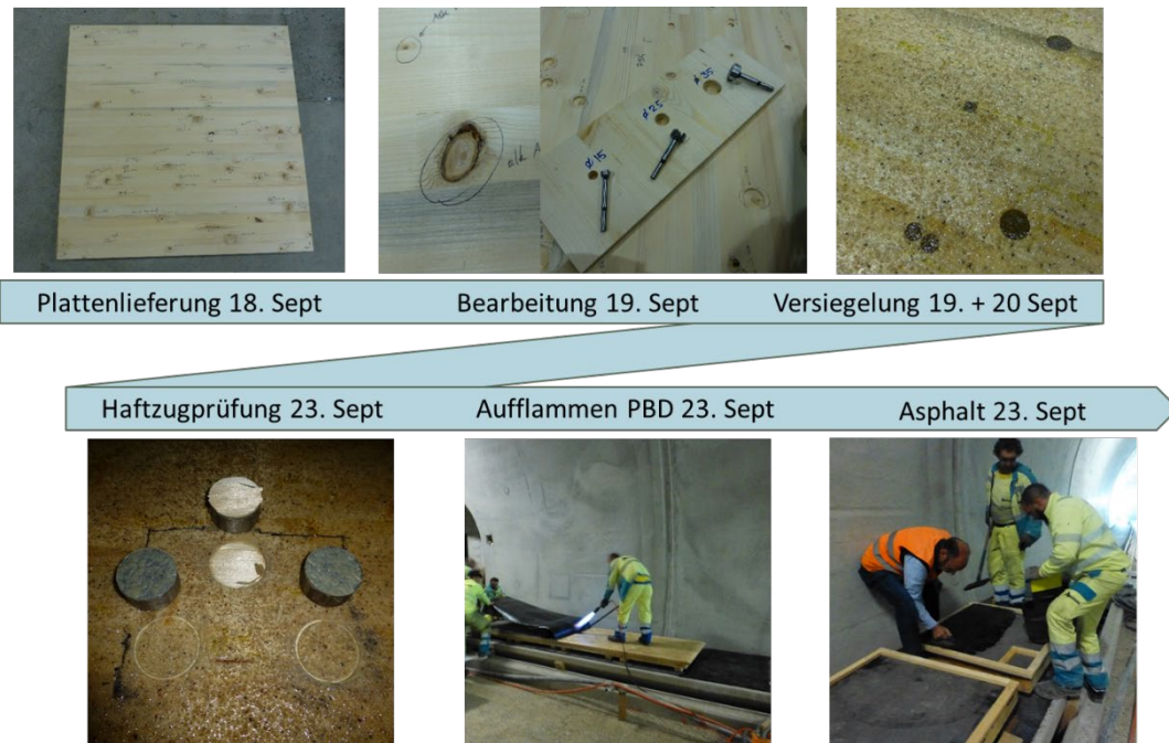
Abbildung 19 : Darstellung der Ablauf der Prüfserie 03 in Biel, von der Plattenlieferung bis zum Asphalteinbau
