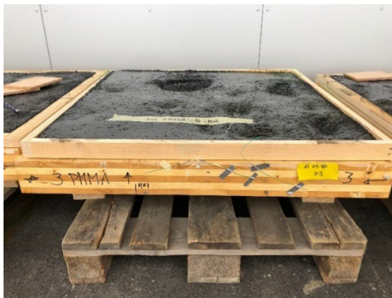
Abbildung 44 : Platten (BSP) mit PMMA-Abdichtung nach dem Einbau des MA ; links Platte 3 (PMMA-Abdichtung ; MA 11 40 mm ; 230 °C); rechts Platte 6 (PMMA-Abdichtung; MA 8 25 mm; 190 °C
