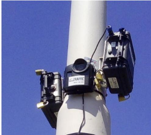
**Abb. 10** Webcam (Gerät in der Mitte).
