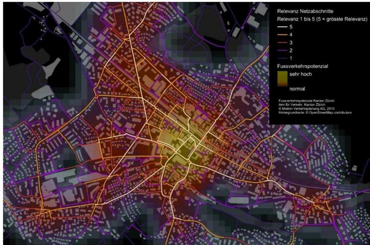
**Abb. 3** Kanton Zürich Fussverkehrspotenzial und Umlegung auf Fusswegnetz (Beispiel Uster) (Methodik: Bubenhof et al. 2019)
