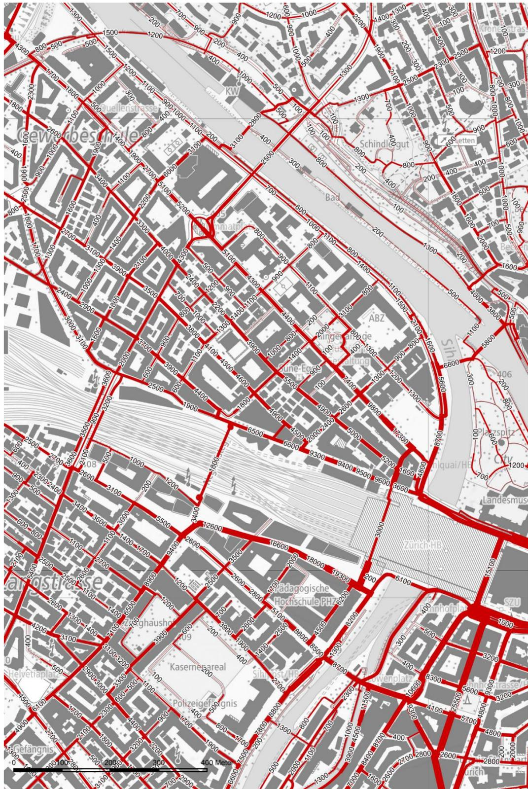
**Abb. 60** Belastungsplan Zürich, DTV mit Berücksichtigung der Naherholung (Z2) und der Lärmbelastung
