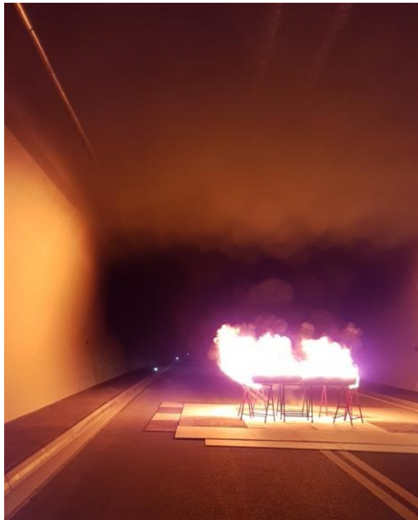
Abb. 4 Foto eines Brandversuchs. Die OLE ist gut sichtbar (links), eine Brandnotbeleuchtung ist vorhanden, aber nicht sichtbar. Beide waren eingeschaltet.
