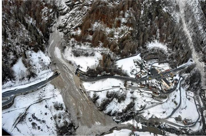
**Abb. 6** Lawingalerie Saastal, Überfließen der Galerie, 10 Januar 2018 (Foto: P. Stöbner).
