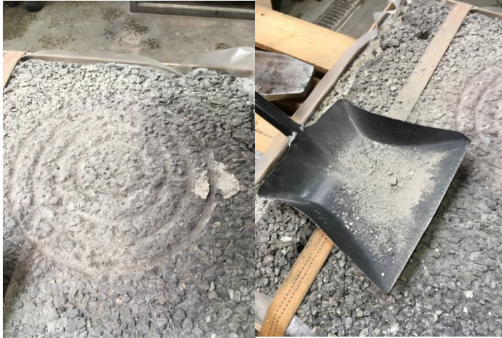
Abb. 22 Belagsstück AC MR 6 nach der Prüfung bei 20°C
