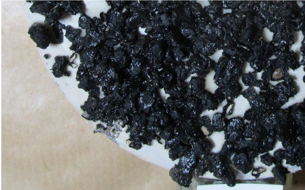
Abb.74 Ausgezogene Körner aus einer SDA 4-16 Platte; die Innenwand der Poren ist glänzend, die Kontaktflächen hingegen erscheinen matt.
