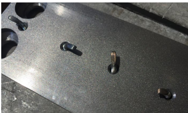
Abb. 24 Ansicht der Bürsten Konstruktion analog Spikes nach der Prüfung
