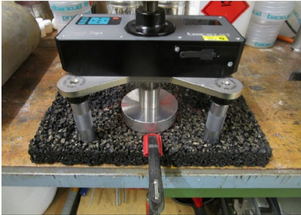
Abb.36 Haftzugvorrichtung mit Proceq DY-216 Gerät und aufgeklebtem Stempel
