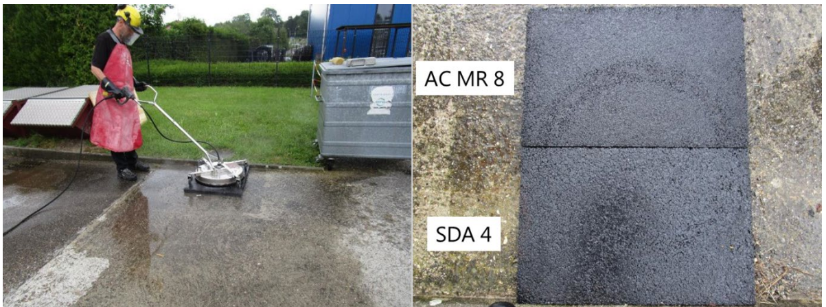
Abb.32 Kärcher Hochdruckgerät (500 bar) und Runddüse auf SDA 4-16 und AC MR 8 Platten
