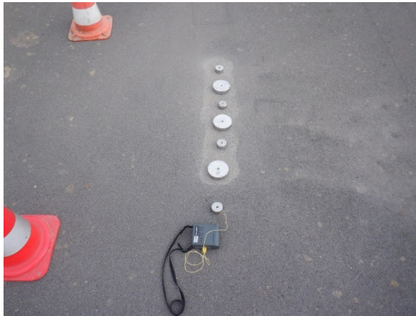
Abb.58 Abzugsstempel der Durchmesser 50 mm und 100 mm
