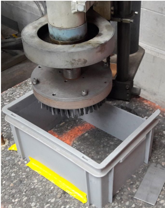
Abb. 17 Erster Versuch einer Bürste analog Strassenreinigung zur Erzeugung von Kornausbrüchen
