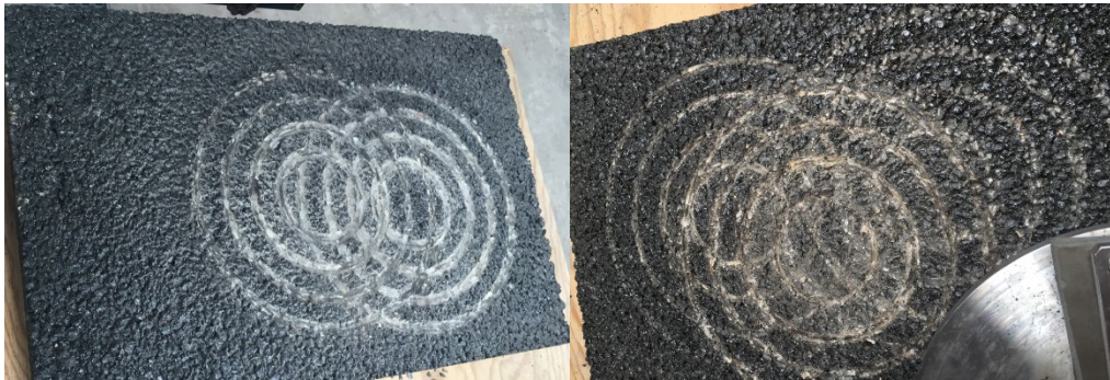
Abb. 23 Prüfplatte nach der Prüfung bei 20°C (links) und bei 60°C (rechts)
