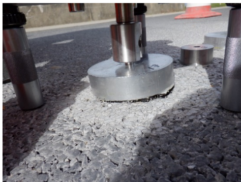
Abb.60 Ungleichmässig (schief) abgezogener Stempel des Durchmessers 100 mm
