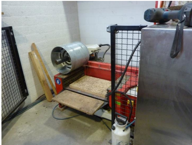
Abb.5 Spurrinnenverdichter mit modifizierter Verdichtungseinrichtung (Walze)
