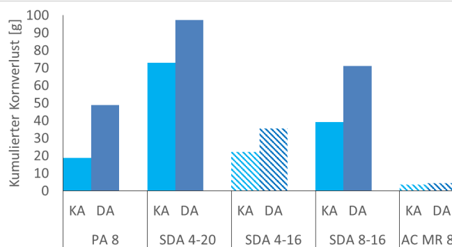
Abb.15 Ermittelten Kornverluste nach 10 Doppelzyklen der Mischgutsorten SDA 4-20, SDA 8-16 und PA 8 sowie schraffiert SDA 4-16 und AC MR 8 im Vergleich Karlsruhe und Darmstadt
