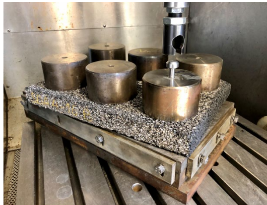
Abb.41 Schematische Darstellung der Prüfkörperverteilung (links), aufgeklebte Abzugstempel (rechts)
