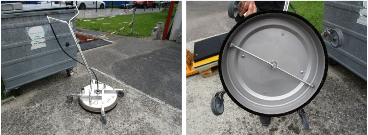
Abb.31 Kärcher Hochdruckgerät (500bar) und Runddüse auf in situ Belag
