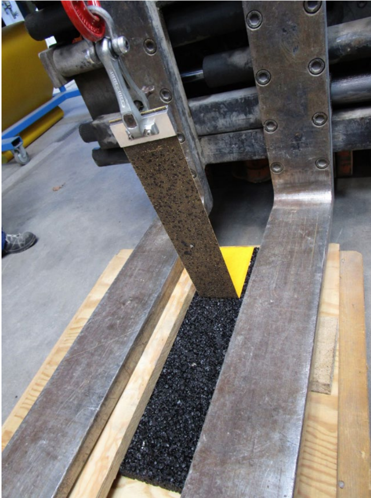
Abb.28 Abziehen des Markierungsstreifens mit Hallenkran
