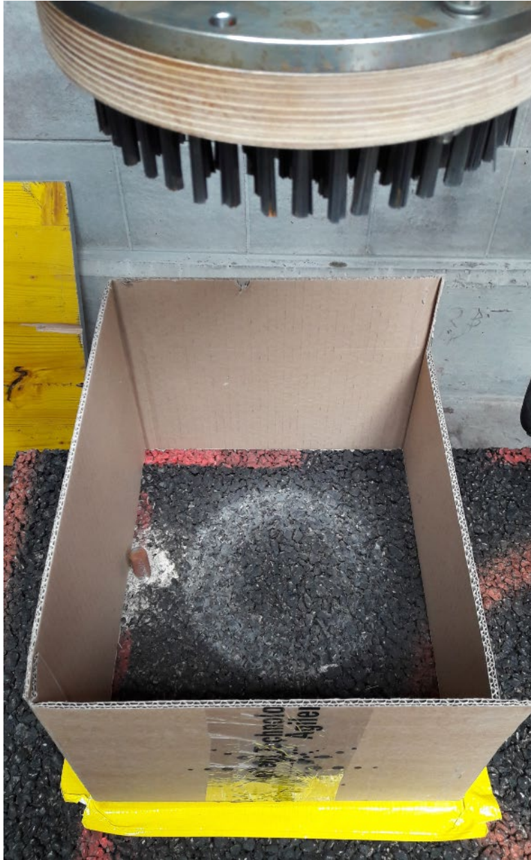
Abb. 18 Kornausbrüche bzw. Abrieb durch Bürsten
