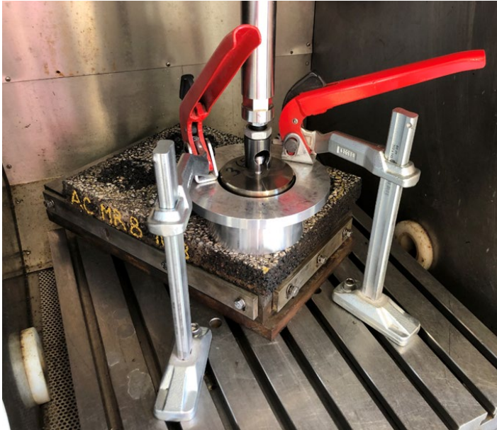
Abb.42 Aufbau mit Stahlring und Schraubzwingen in der Universalprüfmaschine UVP
