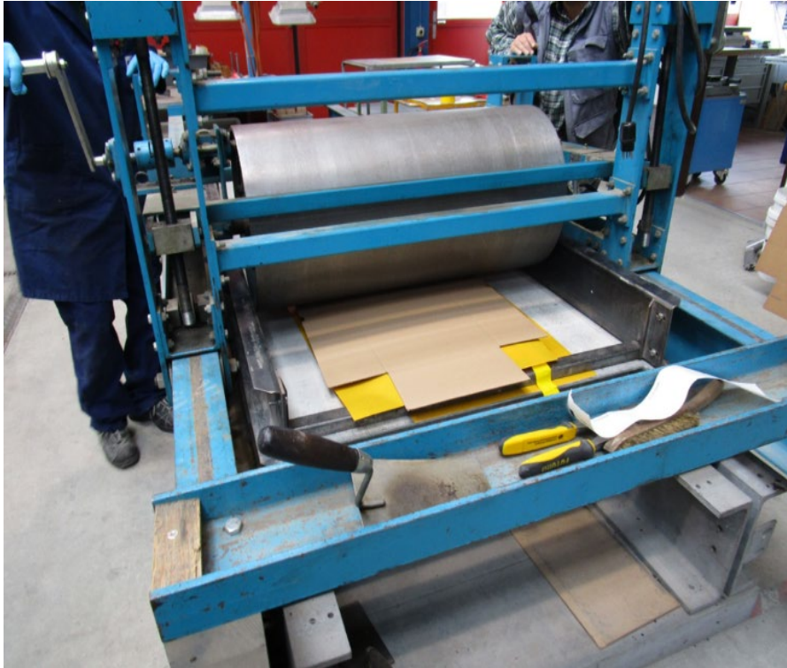
Abb.26 Anpressen der Markierungsstreifen mit Walzverdichter
