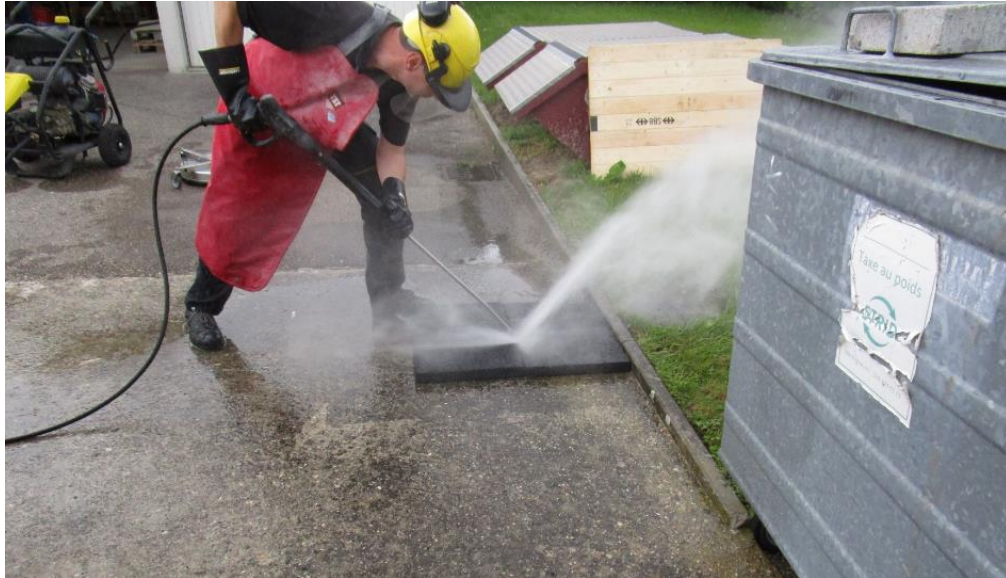
Abb.33 Kärcher Hochdruckpistole (500 bar) und mit einer Flachdüse
