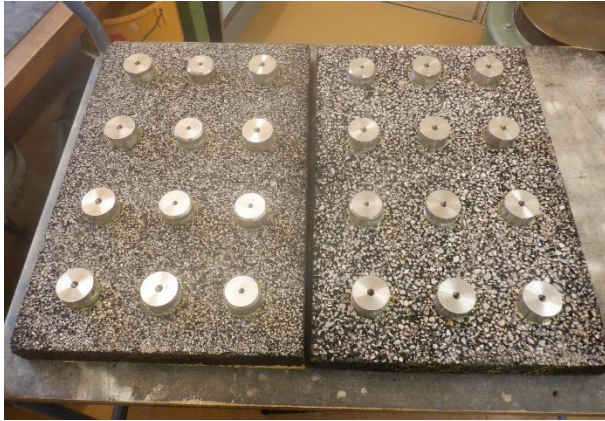
Abb.51 Verteilung der 50 mm Stempel auf den SDA 4-16 und SDA 8-16 Platten.
