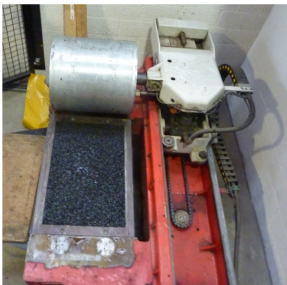
Abb.6 Mit dem modifizierten Spurrinnenverdichter hergestellte Platte
