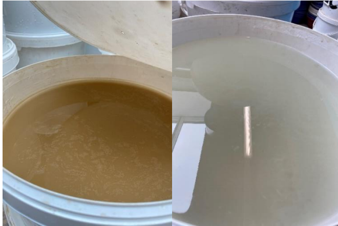
Abb.8 links: Wasser mit Feinanteil unmittelbar nach dem Waschen – rechts: Eimer mit Wasser und abgesetztem Feinanteil, noch immer trüb
