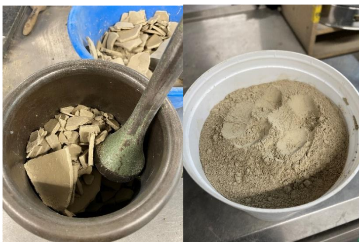
Abb.10 links: Verkleinern des getrockneten Anteils im Mörser – rechts: fertig gemahlener Feinanteil bereit für die Zumischung zum Gemisch.
