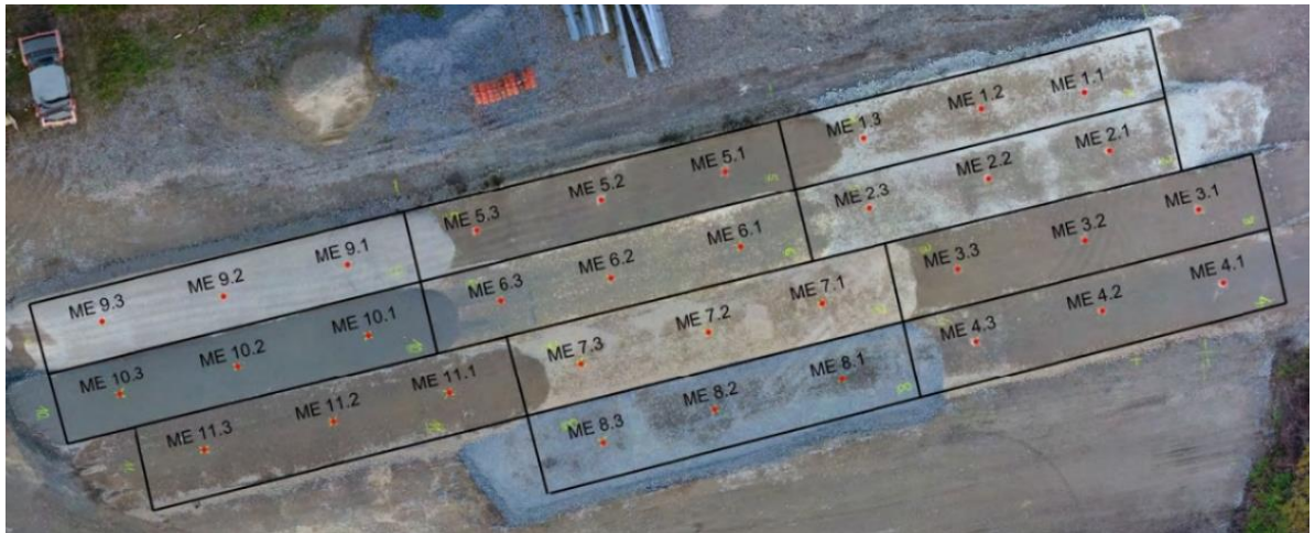
Abb.5 Messpunkte für die ME-Versuche
