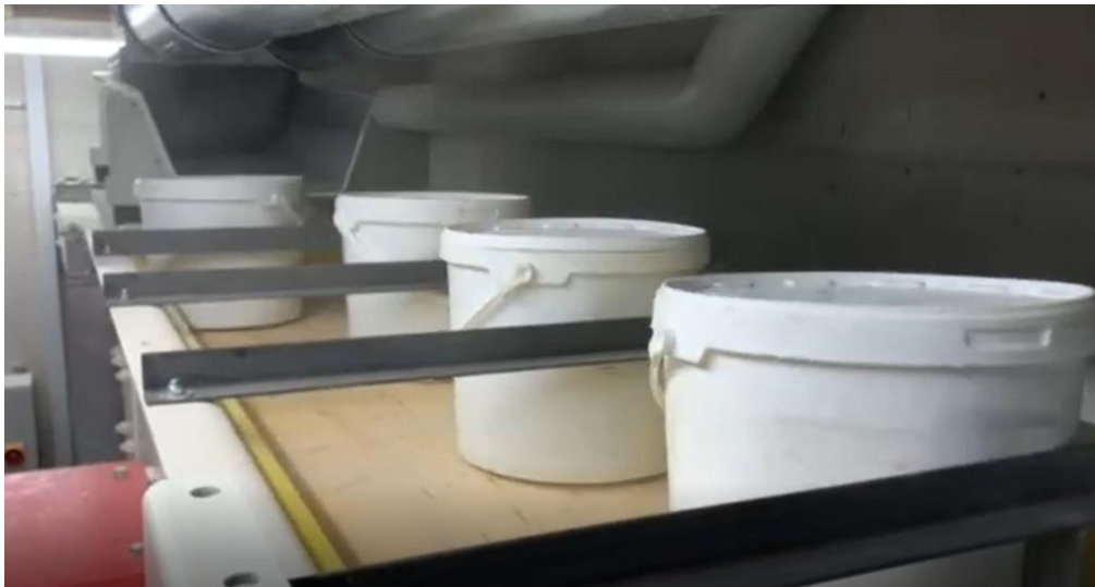
Abb.7 Probekessel auf dem Siebdeck, um Feinanteil in Beton-Gemischen zu generieren
