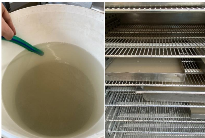
Abb.9 links: Abschöpfen des Wassers, Feinanteil befindet sich am Boden des Eimers – rechts: das verbleibende Wasser wird mit dem Feinanteil auf einem Probeblech im Trockenofen getrocknet
