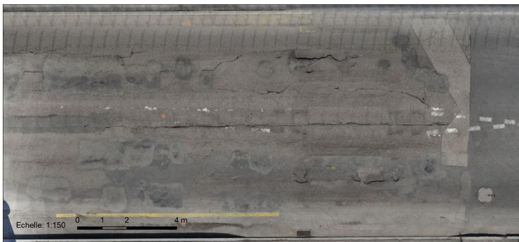
**Figure 67** : Helvétie, orthophoto état 1 (29.03.2019) : apparition de pelades
