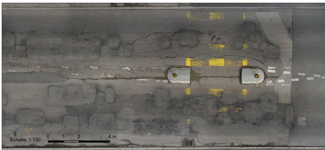
**Figure 12 :** Exemple d'orthophoto de chaussée
