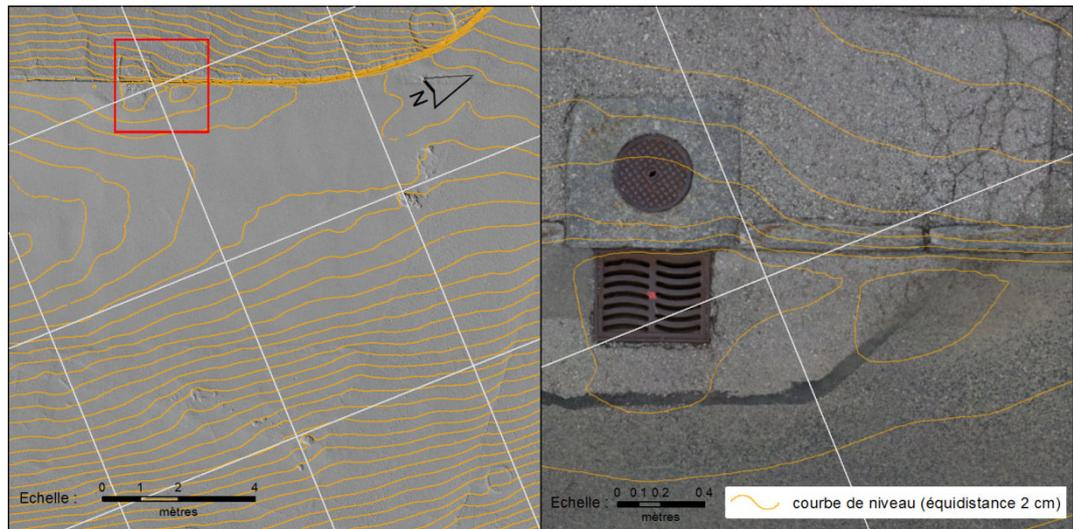
**Figure 29** : Analyse de l'écoulement des eaux de surface et de l'état des infrastructures pour un projet d'entretien ou de réfection (Stavay-Mollondin, état 0, 30.05.2018).
