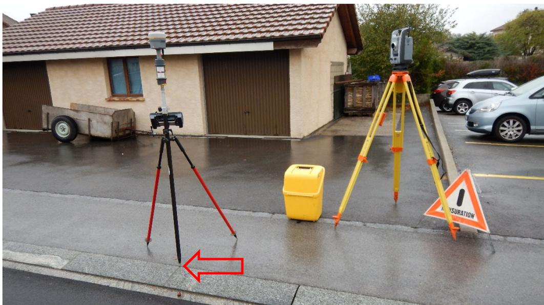
**Figure 4 :** Exemple de détermination d'un point de calage (ici : joint de bordure de trottoir) à l'aide d'une station totale (théodolite), Yvonand (VD) 2016
