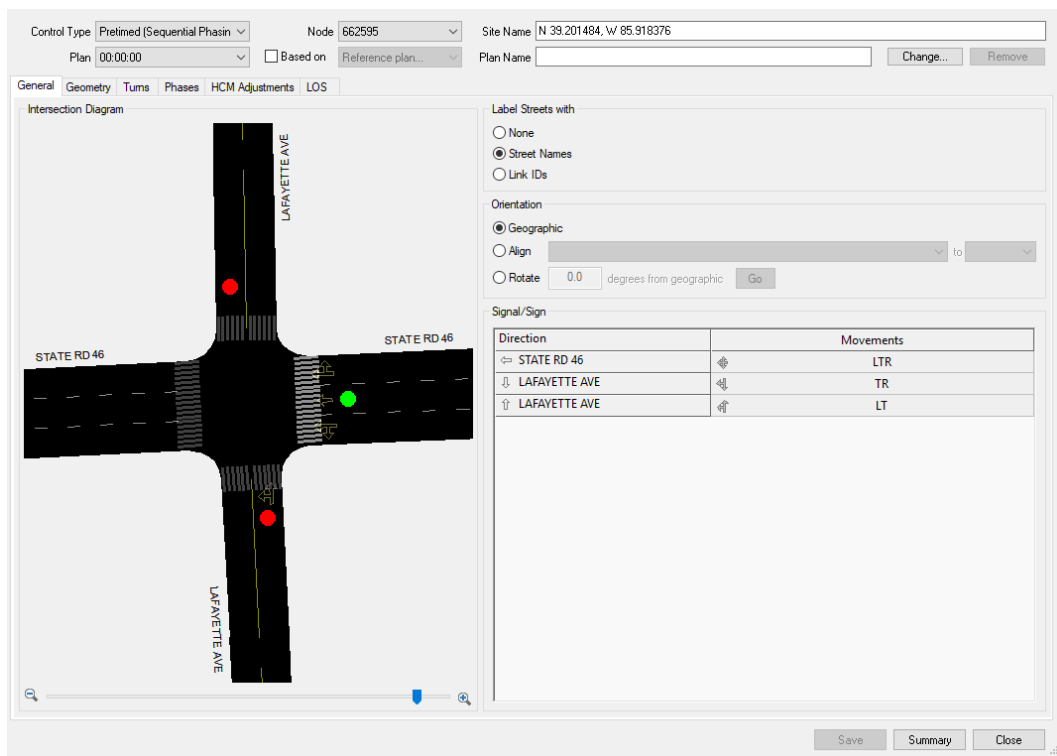
Abb. 48 Intersection Control Editor in TransCAD 8.0: Beispiel einer LSA-signalisierten Kreuzung.
