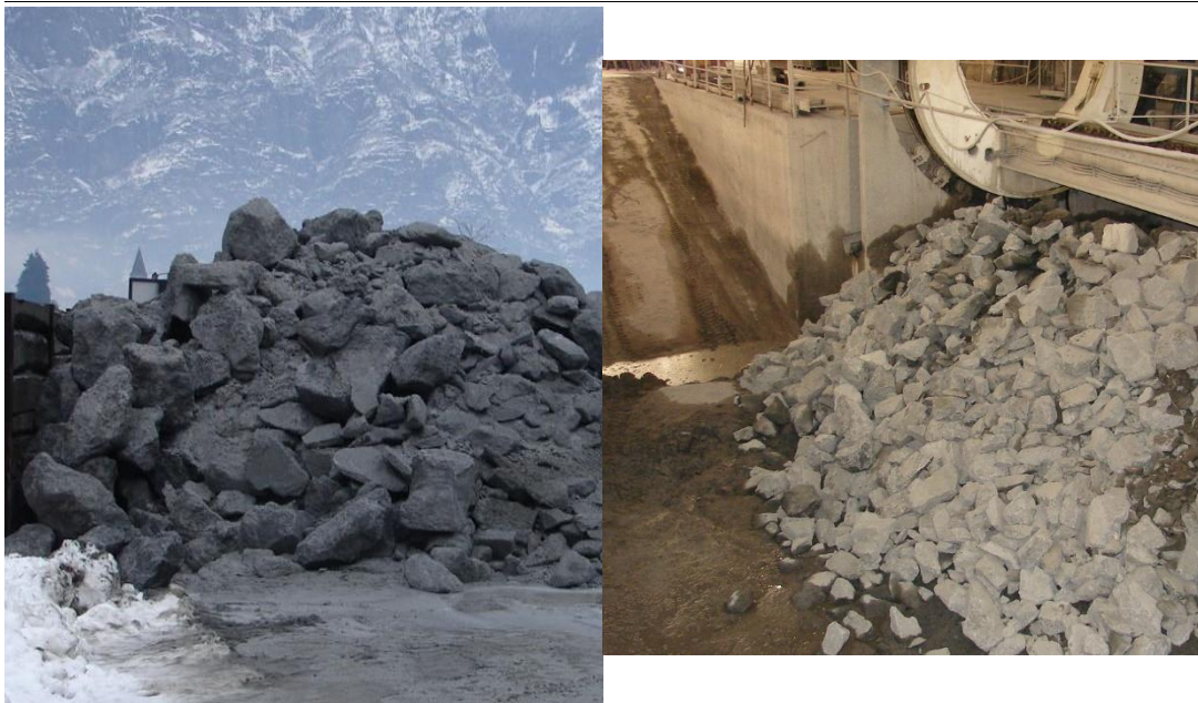
Abb. 14 Rückstände: getrenntes Ausbruchmaterial bei Spezialfällen
