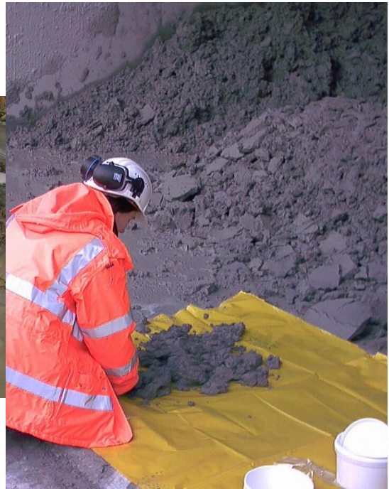
Gepresster MAB-Schlamm in der Probenahmephase
