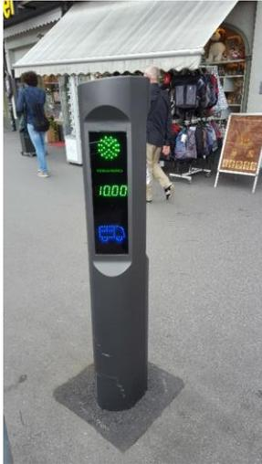
**Abb.71** Automatische Belegungsanzeige mit Countdown der verbleibenden Haltezeit in Interlaken (Foto: Bohne)
