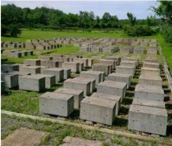
**Abb. 20:** Ausgelagerte Betonblöcke im Feldversuch des CANMET in Ottawa, Ontario
