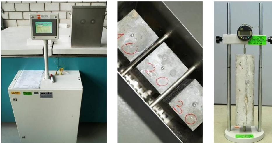
**Abb. 36:** Links: Reaktor für die Beton-Performance-Prüfung (60 °C, 100 % RF); Mitte: Behälter mit geöffnetem Deckel für drei Prüfkörper; rechts: Prüfkörper bei der Längebestimmung.
