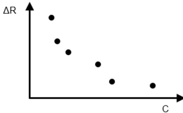
**Abb. 21** Pareto-Front einer Anlage. Jeder Punkt entspricht einer Anlagenstrategie, die durch eine spezifische Kombination  $(C_k, \Delta R_k)$ ,  $k=1,2,\dots$  definiert ist.
