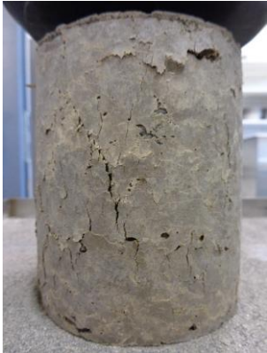
Abb. 17: 30% Ru/70%Ra, 8% Doroport, Druckfestigkeit (li)/Frosten,Bürsten (re)
