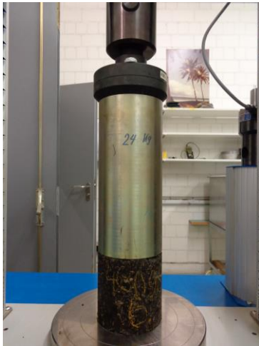
Abb. 9: Bestimmung Zylinderdruckfestigkeit Probe Nr. 46098 (90% Asphaltgranulat, 10% Brechsand, 3.5% Schaumbitumen, 1.0% Doroport)
