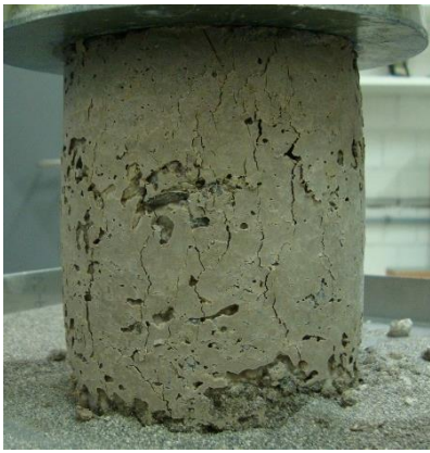
Abb. 15: 100% Rc, 5% Doroport, Druckfestigkeit (li)/Frosten,Bürsten (re)
