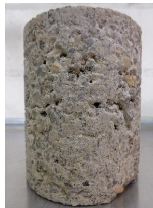
Abb. 17: 30% Ru/70%Ra, 8% Doroport, Druckfestigkeit (li)/Frosten,Bürsten (re)
