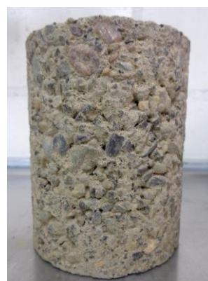
Abb. 18: 33% Ru/33%Ra/33%Rc, 5% Doroport, Druckfestigkeit (li)/Frosten,Bürsten (re)
