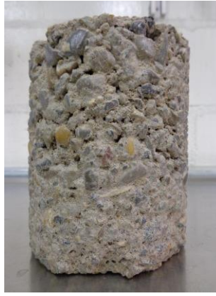
Abb. 15: 100% Rc, 5% Doroport, Druckfestigkeit (li)/Frosten,Bürsten (re)
