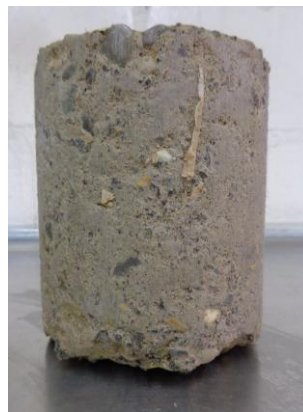
Abb. 16: 50% Ru/50%Ra, 7% Doroport, Druckfestigkeit (li)/Frosten,Bürsten (re)
