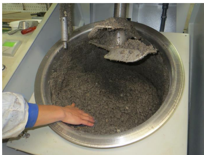
Abb. 7: Fertig gemischtes Mischgut Labormischer Infracast 30 Liter
