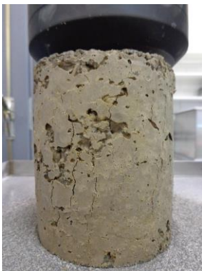
Abb. 18: 33% Ru/33%Ra/33%Rc, 5% Doroport, Druckfestigkeit (li)/Frosten,Bürsten (re)
