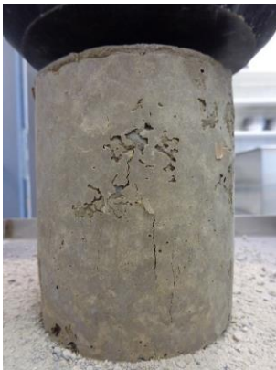
Abb. 16: 50% Ru/50%Ra, 7% Doroport, Druckfestigkeit (li)/Frosten,Bürsten (re)
