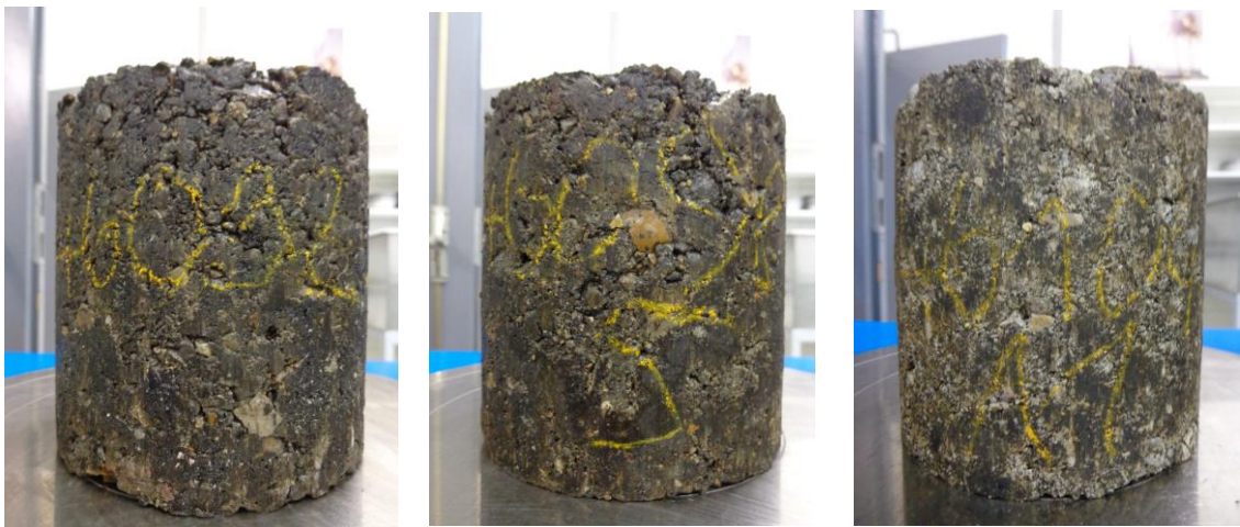
Abb. 10: Prüfkörper nach Bestimm. Druckfestigkeit: 3.5% Schaumbitumen, 1.0% Doroport 46092: 100% Asphaltgranulat, 46098: 90% Asphaltgranulat, 46104: 80% Asphaltgranulat (von links nach rechts)
