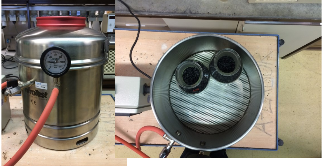
Abb.3 Vakuumbehälter verschlossen (links) und Vakuumbehälter mit der Probe (rechts)
