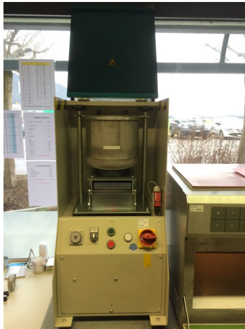
Abb.1 Gerät zur Granulation der Mischgutprobe
