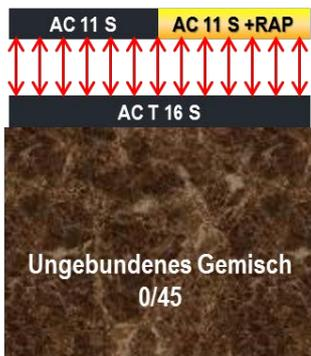
Abb. 45 Symbolische Schichthaftung Testfeld 2
