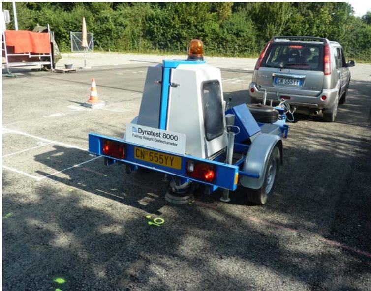
**Abb. 14** FWD Belagsmessung vor der Erstbelastung mit der MLS10 in Zusammenarbeit mit der Universität Parma
