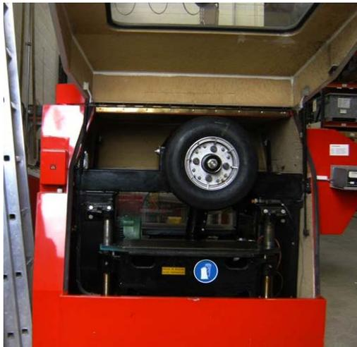
**Abb. 50** Prüfgerät für den Spurbildungstest
