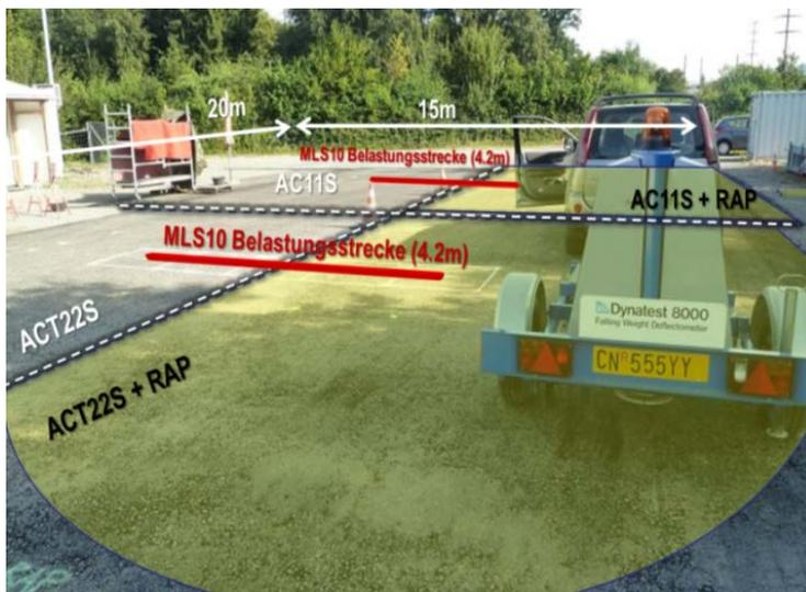
**Abb. 2** Anordnung der aufgebauten Versuchsobjekte- und Referenzen in Testfeld 1 und 2. Oben, graphische Darstellung mit Dimensionen der Beläge und Belastungsausrichtung; Unten, Aufnahme mit hervorgehobenen Einteilungen der Beläge und der Belastungsstrecken
