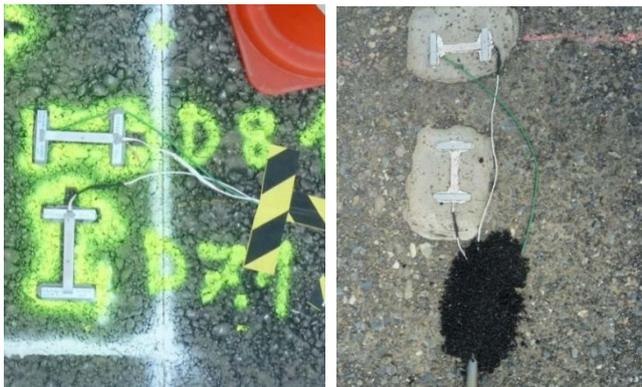
**Abb. 6** (a) Dehnmessstreifen (DMS) im Anlieferungszustand mit angedeuteter Belastungsrichtung und nach Ankleben der Alubalken, (b) schematische Skizze der DMS mit Alubalken, (c) Einbau auf Belag und Fundation
