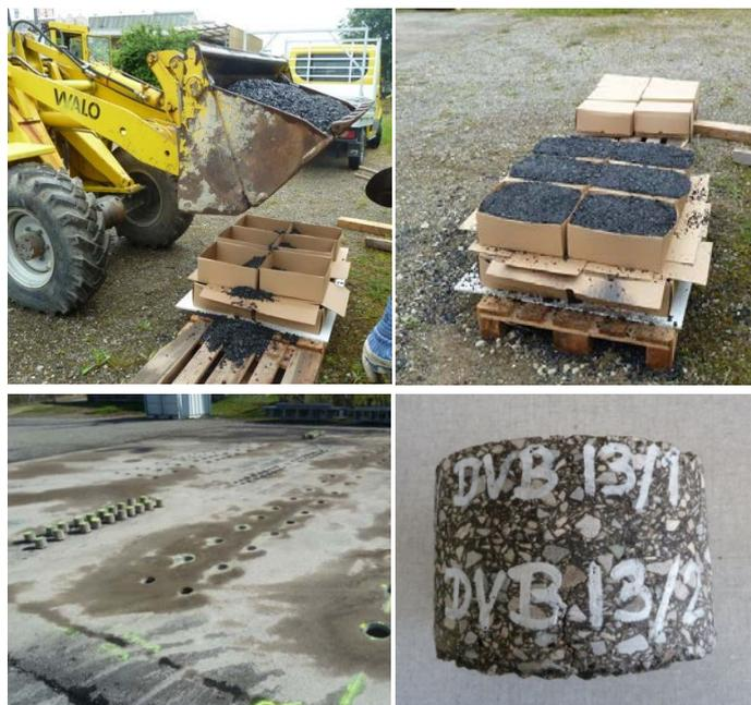
**Abb. 15** Oben, Entnahme des Mischgutes während der Aufbauarbeiten in Lenzburg, Unten, Bohrkerntnahme nach der Messkampagne
