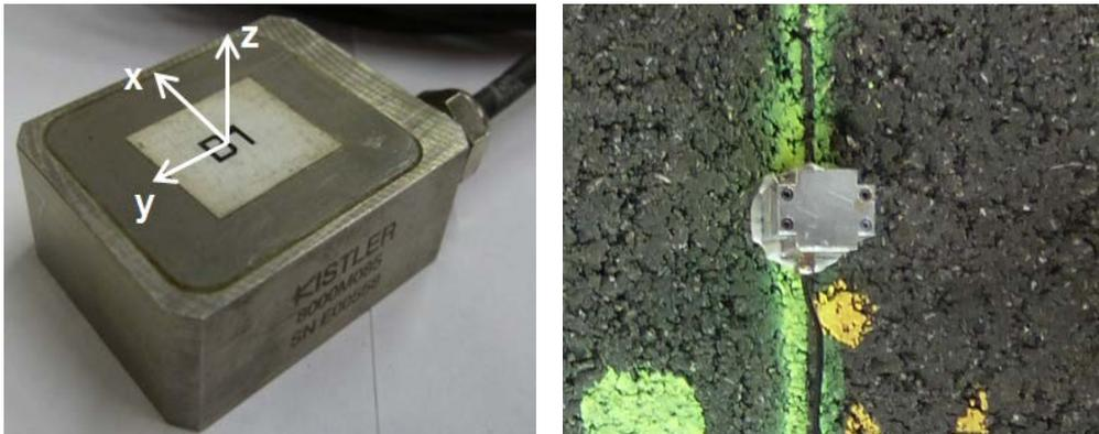
**Abb. 8** Links, Beschleunigungssensoren mit vorgegebenen Koordinatenrichtungen, Rechts auf dem Belag geklebter Sensor
