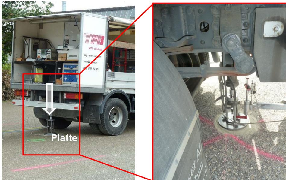
**Abb. 9** Plattendruckversuche auf der Planie der Testfelder
