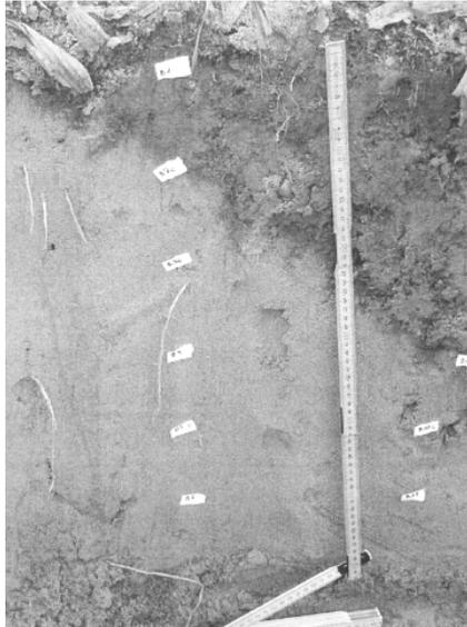
**Abb. 9** Profilbild in Übergangsbereich von Sand- zu Bodenfilter in der SABA Ellenwis. An der Grenzschicht zwischen Boden und Sand ist die dunkel gefärbte Ablagerung von Partikeln aus dem Strassenabwasser zu sehen, welche sich normalerweise an der Bodenoberfläche als Invasionszone zeigt. (vgl. auch Erklärung in Anhang I)
