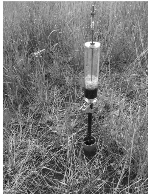
**Abb. 12** Infiltration mit der Tracerlösung.
