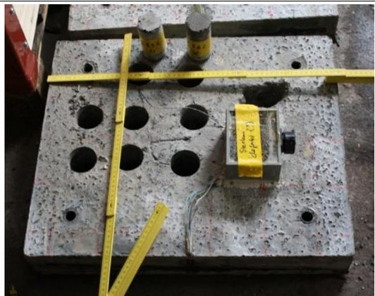
Lage der Bohrkern in Platte E3
