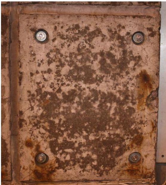
**Abb. 25** Verfärbungen, Rostflecken und Rissbildungen an der Platte H2 nach 12 Jahren Exposition.
