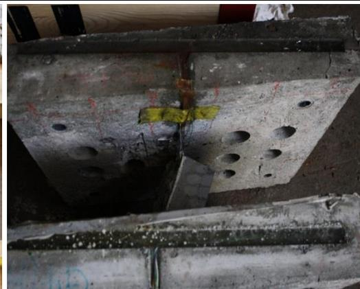
Lage der Bohrkern in Platte H3
