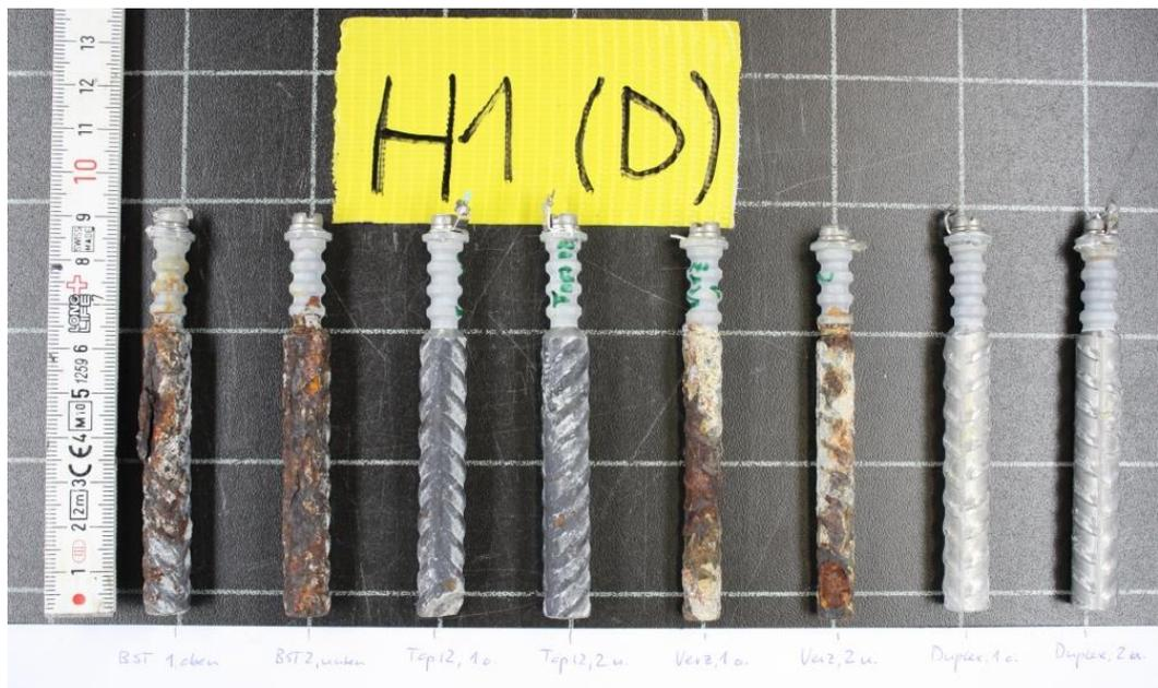
**Abb. X-10** Korrosionszustand der Betonstähle nach dem Ausbau 2012 in der Betonplatte H1 (Typ D). Von links nach rechts: je 2 x Betonstahl oben/unten (10 mm), Top12, verzinkter Stahl, nichtrostender Stahl 1.4462.
