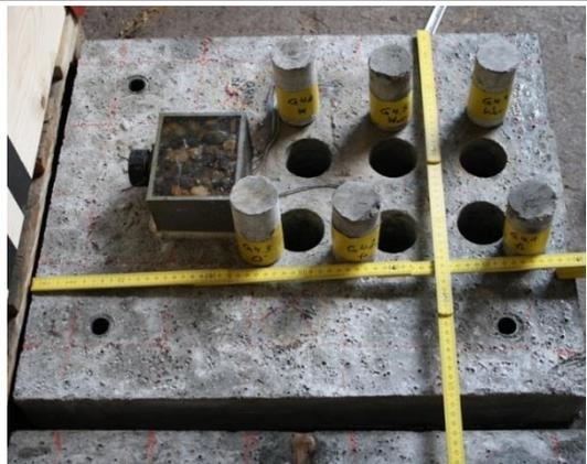
Lage der Bohrkern in Platte G4
