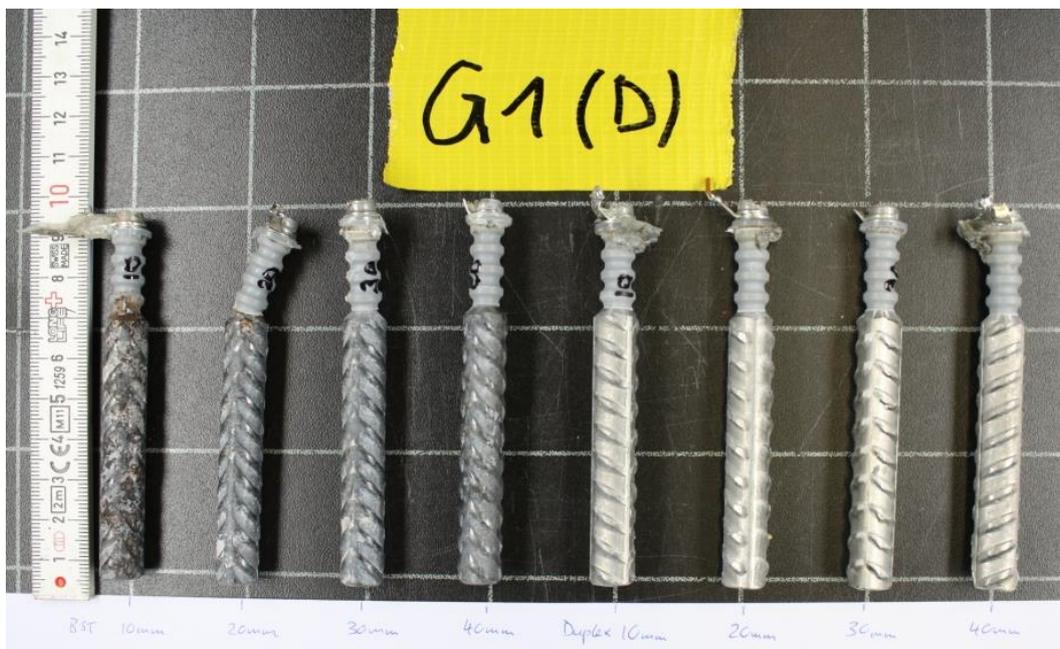
Abb. X-6 Korrosionszustand der Betonstäbe nach dem Ausbau 2012 in der Betonplatte G1 (Typ D). Von links nach rechts: 4 x Betonstahl (10/20/30/40 mm), 4 x Niro Betonstahl 1.4462 (10/20/30/40 mm).
