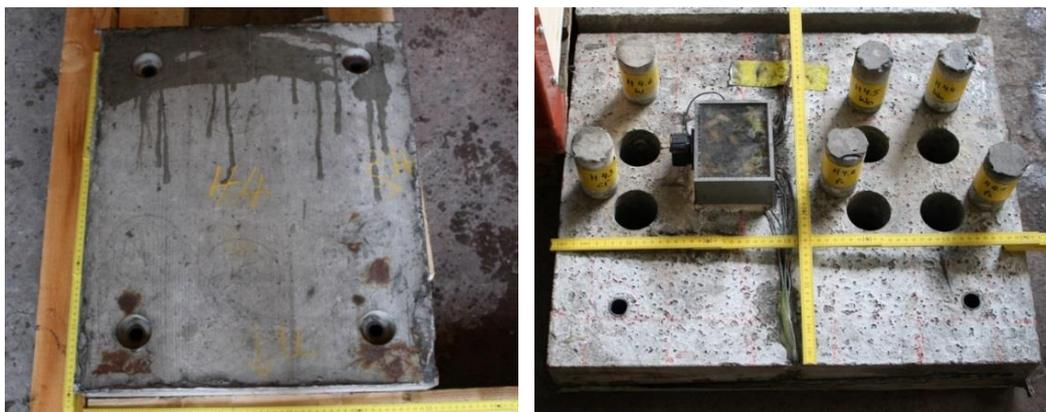
**Abb. 14** Bild links: Vorderseite der Platte H4 vor der Probenahme, Bild rechts: Entnommene Bohrkern aus der Platte H4 – Ansicht Rückseite.
