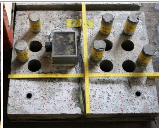
Lage der Bohrkern in Platte H4
