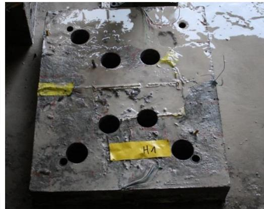
Lage der Bohrkern in Platte H1
