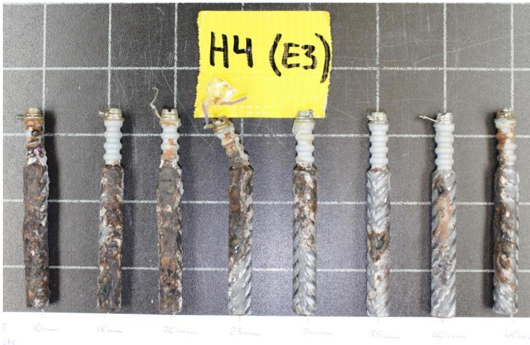
Abb. X-14 Korrosionszustand der Betonstähle nach dem Ausbau 2012 in der Betonplatte H4 (Typ A, Beton w/z 0.5). Bewehrungsüberdeckungen von 10 bis 45 mm (Stufen à 5 mm).
