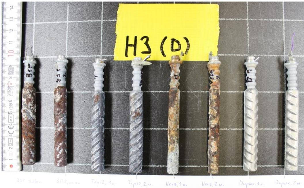
**Abb. X-11** Korrosionszustand der Betonstähle nach dem Ausbau 2012 in der Betonplatte H3 (Typ D). Von links nach rechts: je 2 x Betonstahl oben/unten (10 mm), Top12, verzinkter Stahl, nichtrostender Stahl 1.4462.
