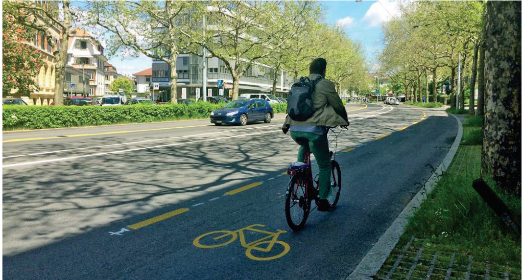
Abb. 34 Breiter Radstreifen (2.50 m breit), Nordring Bern (CH)
