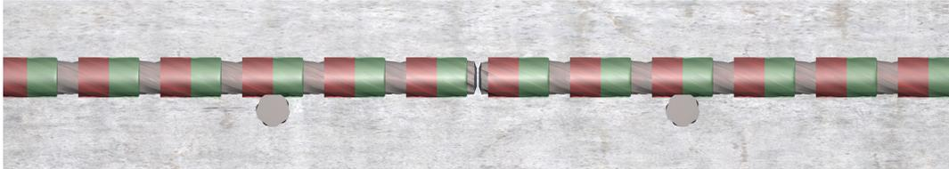
**Abb. 4.5** Remanente Magnetisierung des Bewehrungsstabes
