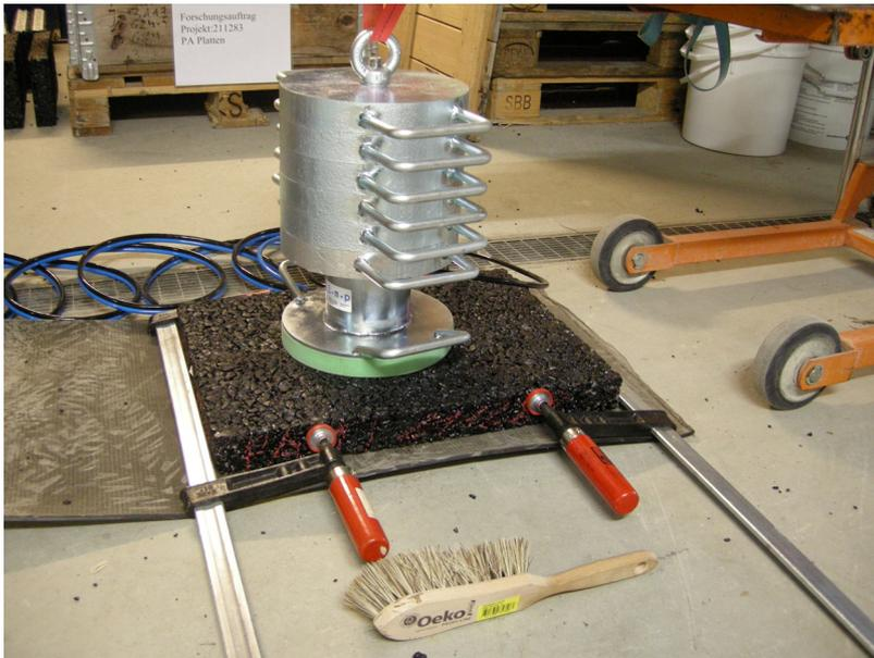
**Abb. 2** Versuchsaufbau zur Bestimmung des Luftströmungswiderstandes
