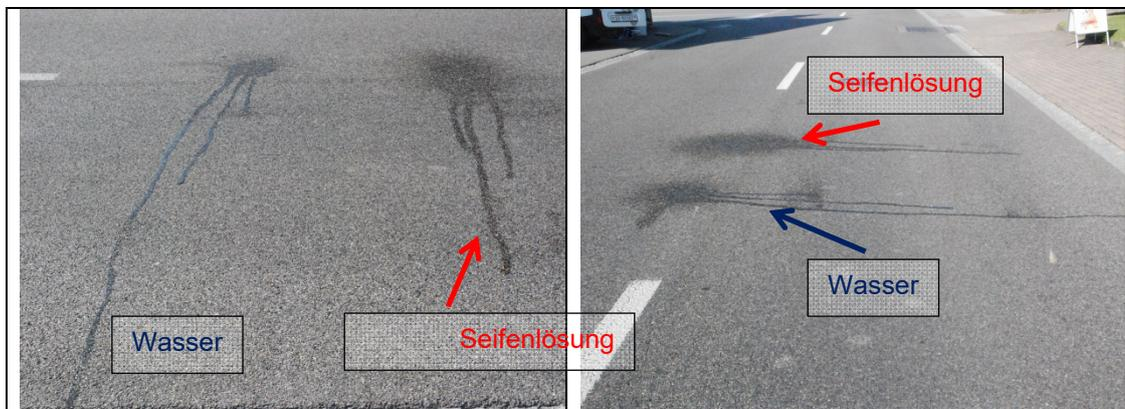
**Abb. 13** Auslaufversuche in situ, bei denen eine definierte Menge Wasser und eine gleiche Menge Wasser-Seifen-Lösung auf eine semi-dichte Oberfläche aufgebracht wurden
