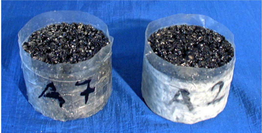
**Abb. 3** Links: Prüfkörper mit Klebeband und Paraffinfolie umhüllt; rechts: nach dem Eintauchen in ein Paraffin-Bad.
