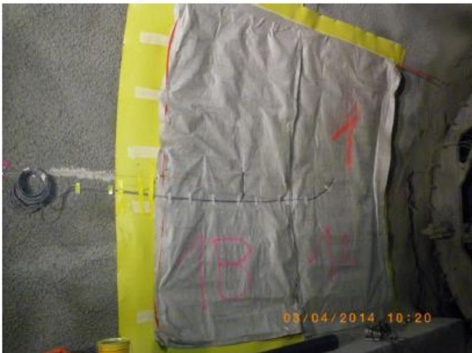
Abbildung 17 montiertes Absorbermodul, mit Temperaturmessfühlern
