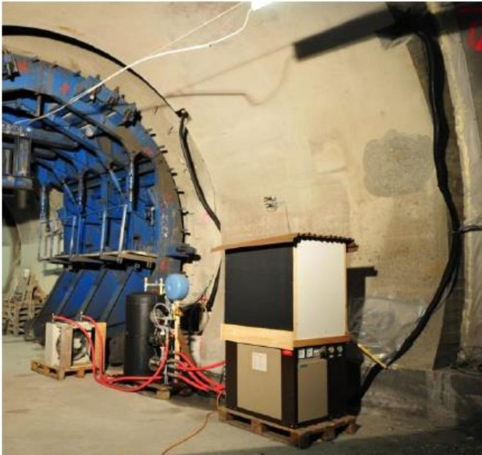
Abbildung 23 Wärmepumpe mit Messanlage
