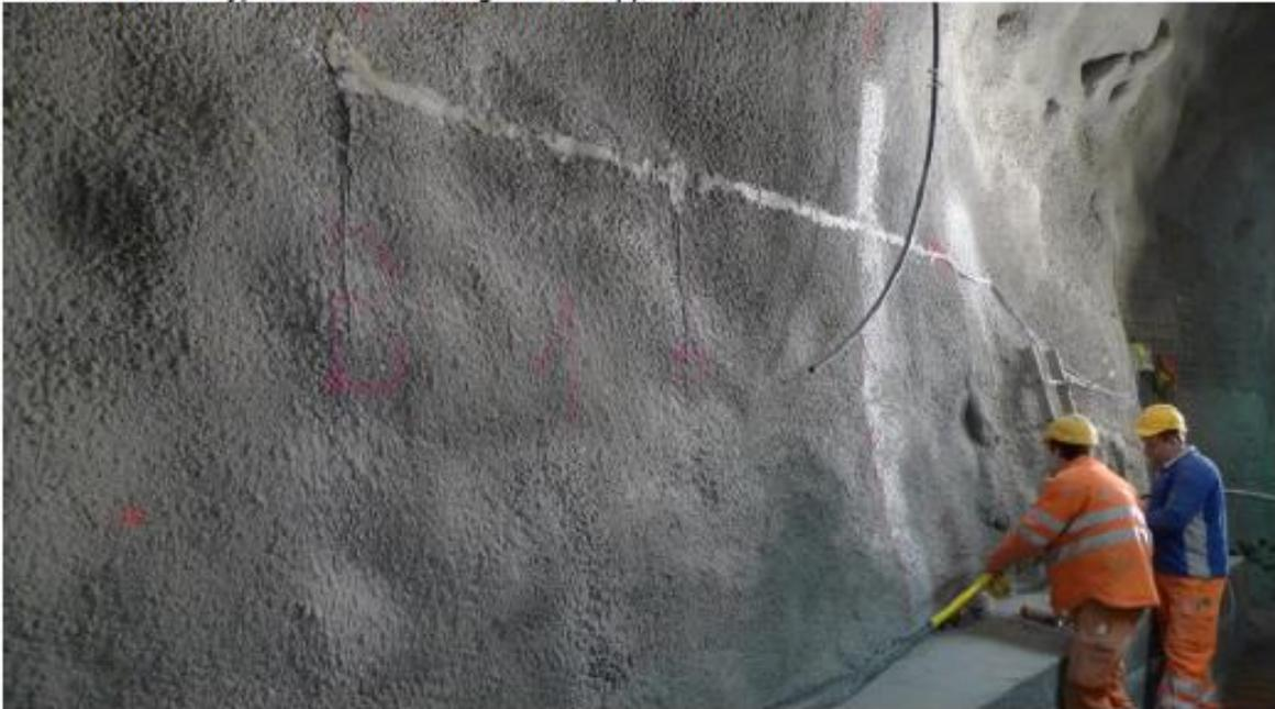
Abbildung 1 Versuchsfeld 2, vor Montage, mit eingebauten Temperaturmessfühlern
