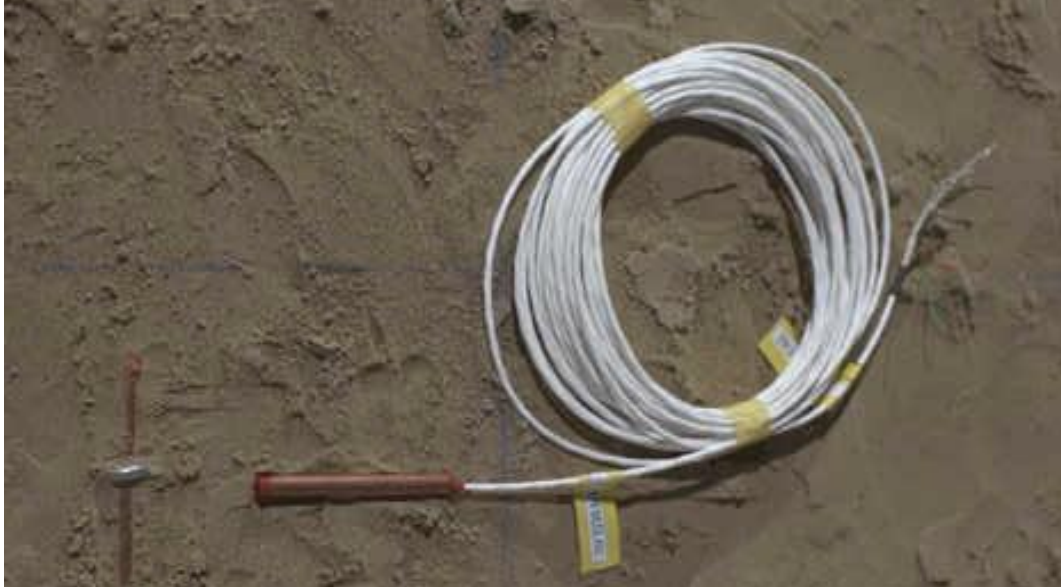
Fig. 20 Jauge de température Pt100.
