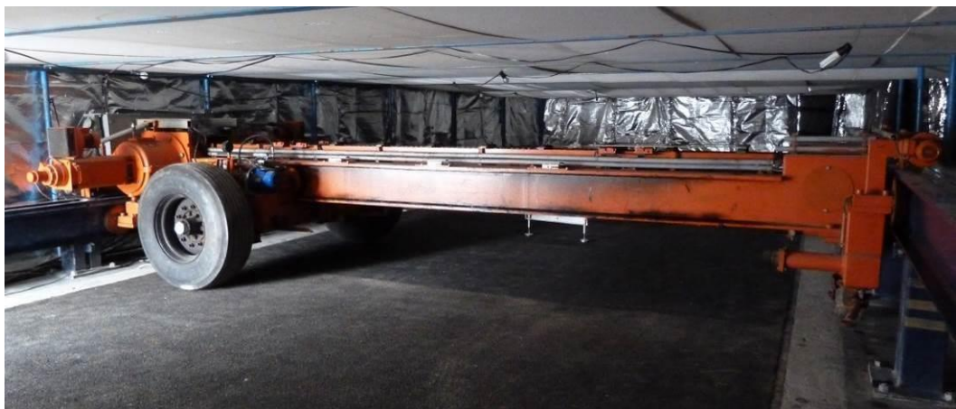
Fig. 23 Photo du simulateur de trafic lourd.
