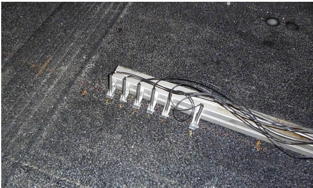
Fig. 21 Jauges de déplacement LVDT.
