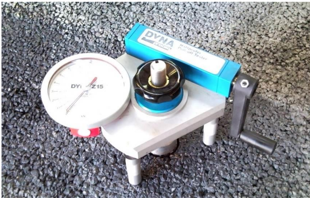
Fig. 34 Appareil pour l'essai d'arrachement Dyna Z15, Proceq
