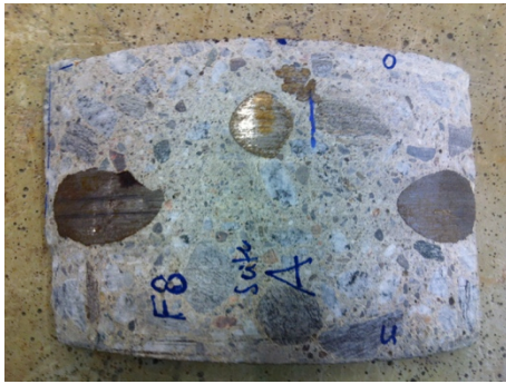
(a) Makro-Aufnahme des untersuchten Bohrkerns bzw. Bewehrungsstahls. Die untere Seite des Bohrkerns entspricht der Betonoberfläche an der Deckenuntersicht des Tunnels.
