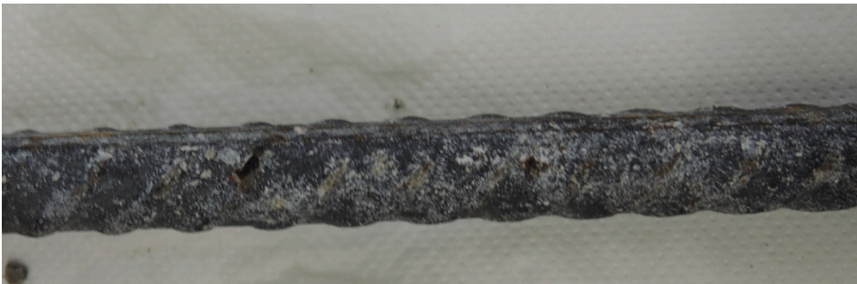
Abb. 37 Fotografische Dokumentation der Korrosionsstellen auf dem herausgelösten Bewehrungsstahl bei Prüfkörper G3. Dunkelbraune/schwarze Korrosionsprodukte.
