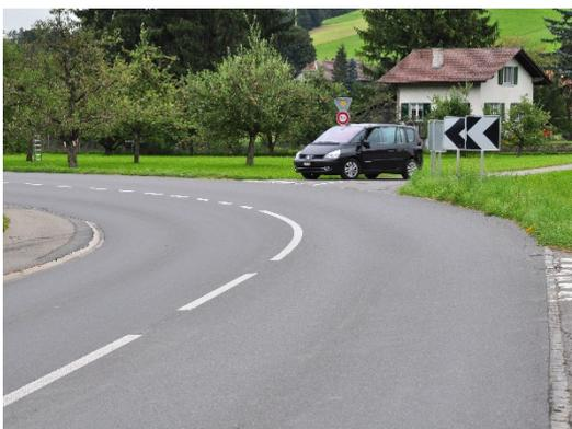
**Abb.21** Ausserortsstrasse: Kurvenleitpfeile zur Verdeutlichung der Linienführung
