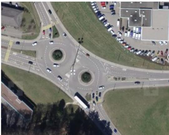
**Abb. 6** Beispielbild Sonderform Doppelkreisel [map.geo.admin.ch]
