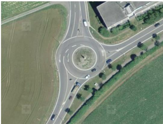
**Abb. 5** Beispielbild Sonderform Spiralkreisel [map.geo.admin.ch]
