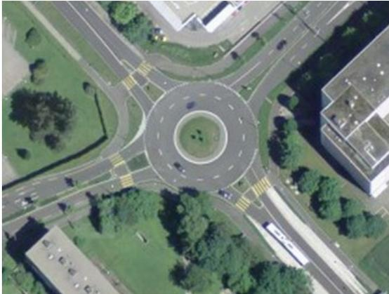
**Abb. 1** Beispiel Kreisel mit zweistreifiger Kreisfahrbahn [map.geo.admin.ch]
