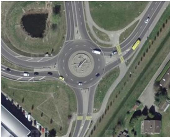
**Abb. 2** Beispiel Kreisel mit zweistreifiger Kreisfahrbahn [map.geo.admin.ch]
