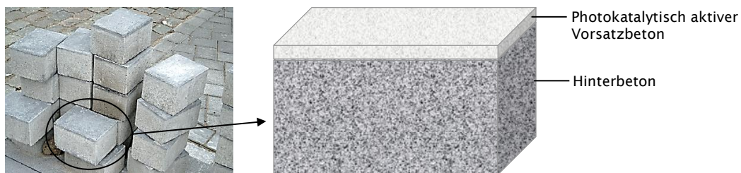
Abb. 10 Photokatalytischer Beton-Verbundstein. Links: Photographie. Rechts: Schematische Darstellung. (Abbildung verändert nach Crispino, 2014 [25]).
