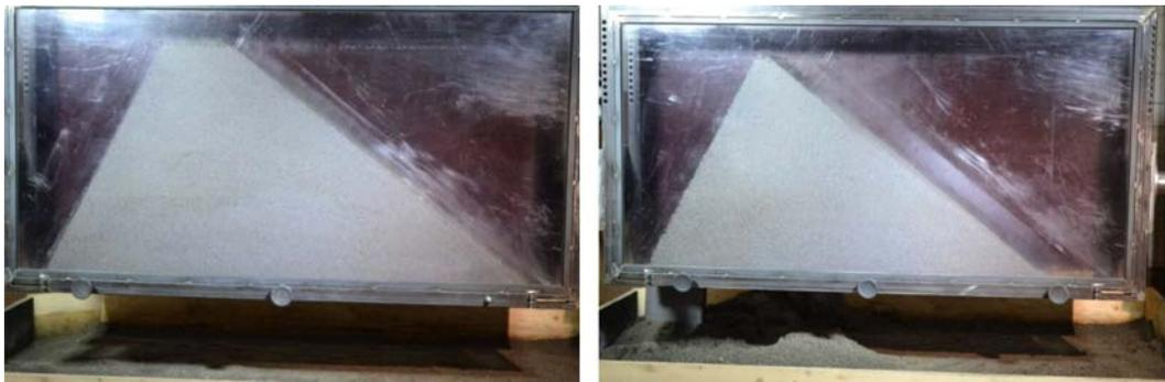
**Abb. 3.5** Asymmetrische Dammgeometrie des Typs 2145 mit einem Böschungswinkel von  $62.6^\circ$  auf der „Bergseite“ und einem Böschungswinkel von  $37.3^\circ$  auf der „Talseite“. Links: Kronenstärke Typ A, rechts: Kronenstärke Typ D.
