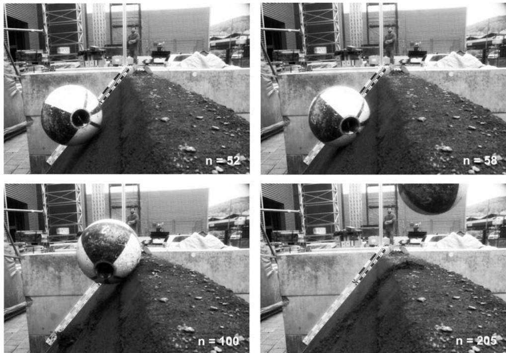
**Abb. 4.25** Versuch *impakt\_05*:  $n = 52$ : Aufschlagpunkt,  $n = 58$ : Block erreicht eine maximale Eindringtiefe von ca. 3 cm bevor eine Bewegung nach oben erfolgt (Messung aus den Fotos),  $n = 100$ : Block erreicht die Dammkrone und schiebt Material vor sich her,  $n = 205$ : Block überspringt den Damm.
