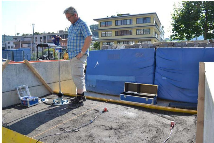
**Abb. 5.1** Dynamischer Plattendruckversuch mit dem Gerät Terratest 4000 USB auf der Messebene E2 eines Versuchsdamms, d.h. auf ca. halber Dammhöhe. Zudem erkennbar die beiden Geophone für die Messung nach der Methode der Spektralanalyse von Oberflächenwellen (SASW).
