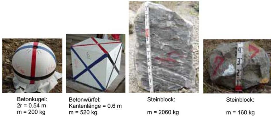
Abb. 2.27 Von Usiro et al. verwendete Sturzkörper [71].
