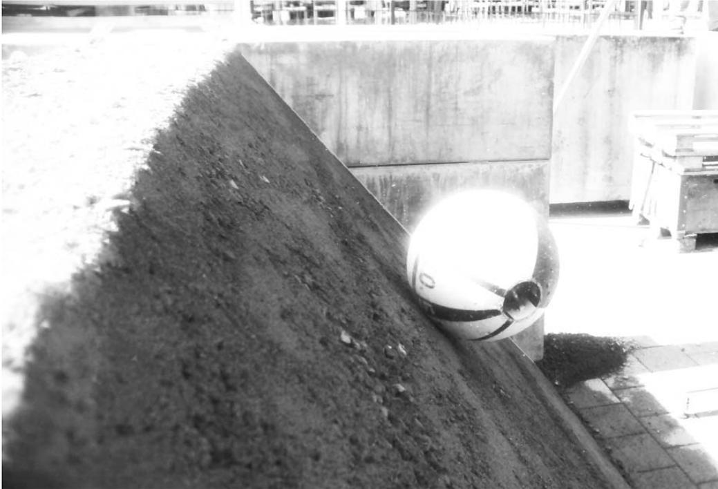
**Abb. 4.15** Aufschlagpunkt beim Versuch *impakt\_02*, Freibord ca. 1.5 Blockdurchmesser.
