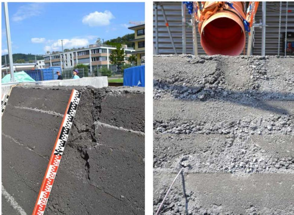
**Abb. 4.38** Versuch *impakt\_07*: Links: Beschädigung des Damms auf der „Bergseite“ nach dem Impact, rechts: Durch die Betonkugel beim Überrollen des Damms erzeugte ausgewalzte Rinne auf der „Talseite“ des Damms.
