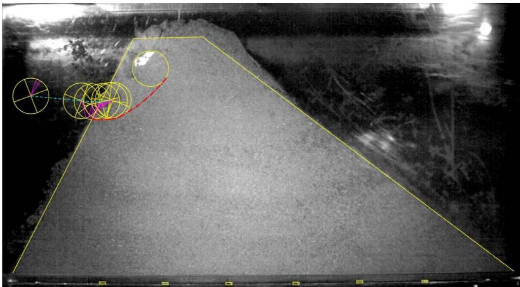
**Abb. 3.52** Konstruktion des Bewegungsablaufs beim Versuch St-2145-A-01 aus Bildern zu Beginn und am Ende des Impaktvorgangs.
