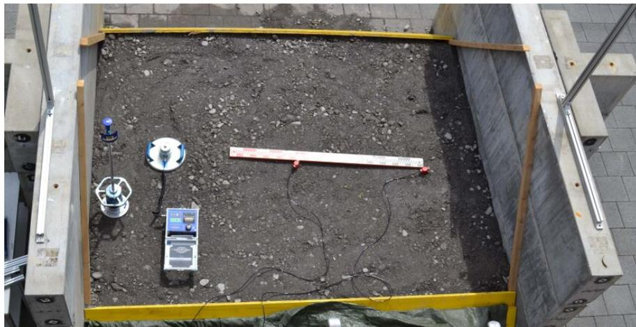
**Abb. 5.13** Anordnung der Geophone für die SASW-Messung auf Messebene E1, das dynamische Lastplattengerät dient in dieser Versuchsanordnung als Signalquelle.
