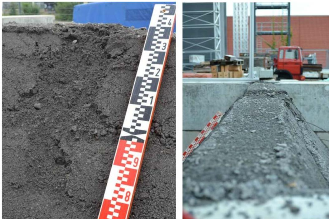
**Abb. 4.33** Versuch *impakt\_06*: Links: „Aufschlagmarke“, rechts: Die Deformation der Krone infolge des Impakts ist deutlich zu erkennen.
