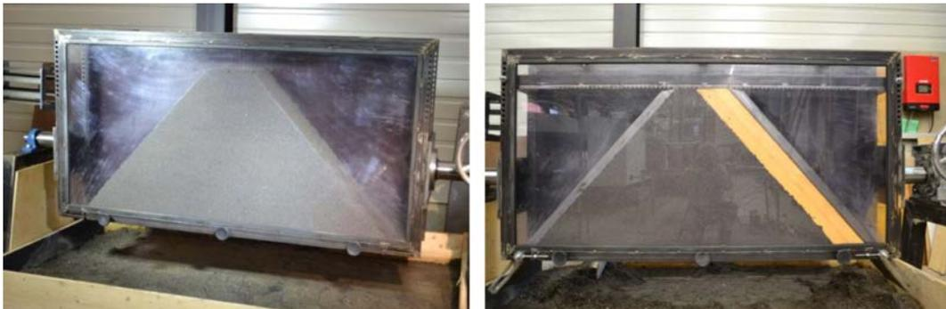
**Abb. 3.4** Symmetrische Dammgeometrie des Typs 1111 mit einem Böschungswinkel von  $47.8^\circ$  sowohl auf der „Bergseite“ als auch auf der „Talseite“. Links: Kronenstärke Typ A, rechts: Kronenstärke Typ D.
