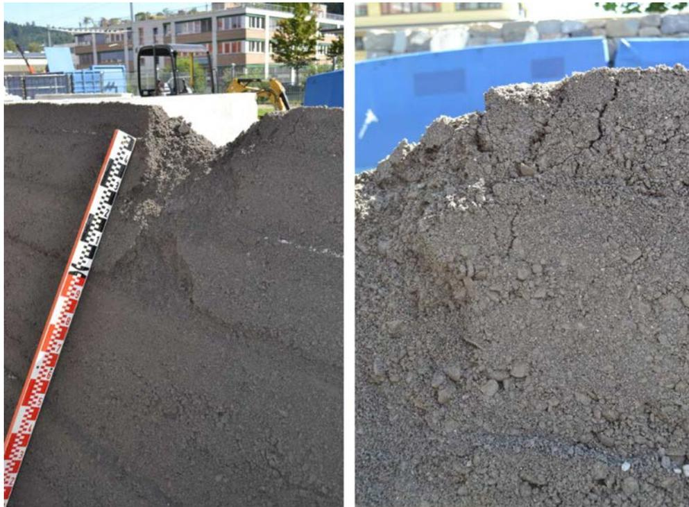
**Abb. 4.43** Versuch *impakt\_08*: Links: Durchschlagene Dammkrone und Ausbruch unterhalb des Aufschlagpunkts, rechts: Rissbildung in der Dammkrone nach dem Impact.
