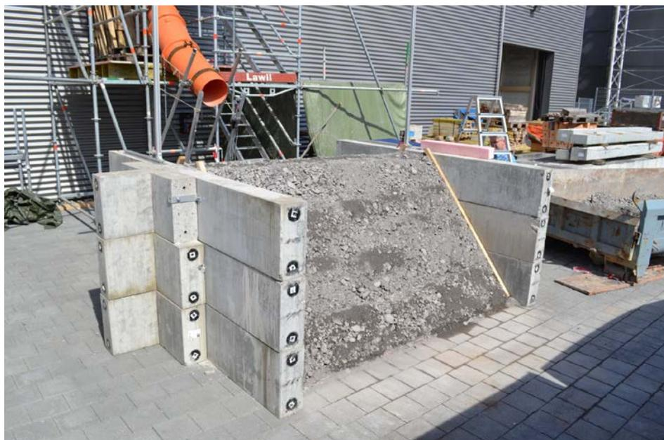
**Abb. 4.3** Dammkörper für den Versuch *impakt\_01* mit dem Versuchsboden *DBS1*
