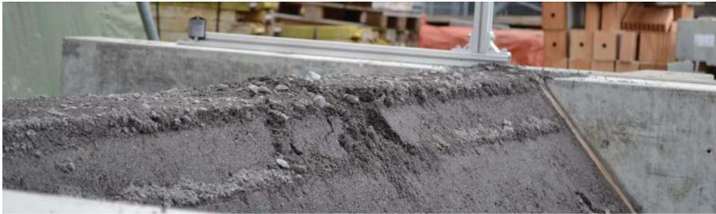
**Abb. 4.34** Versuch *impakt\_06*: Beschädigung an der Dammkrone auf der „Talseite“.
