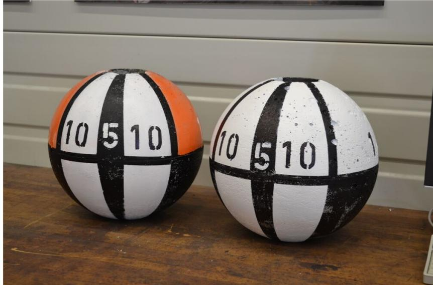
**Abb. 4.2** Impaktkörper aus Beton für die 3D-Versuche.  $m = 50.2 \text{ kg}$ ,  $2r = 0.35 \text{ m}$
