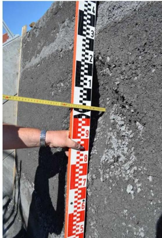
**Abb. VI.5** Versuch *impakt\_03*: Ergebnis der Aufnahme des Damms mit dem 3D-Scanner nach dem Impact, Vertikalschnitt (links) und manuelle Messung der Eindringtiefe (rechts).
