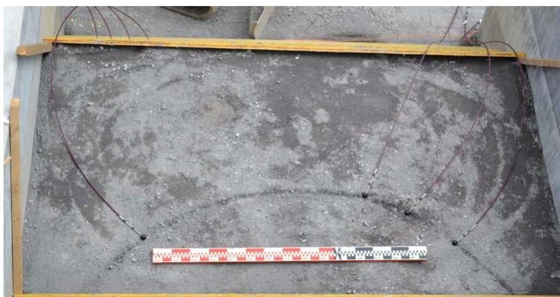
**Abb. 4.8** Radial ausgerichtete push-pull-Kabel auf der Messebene C
