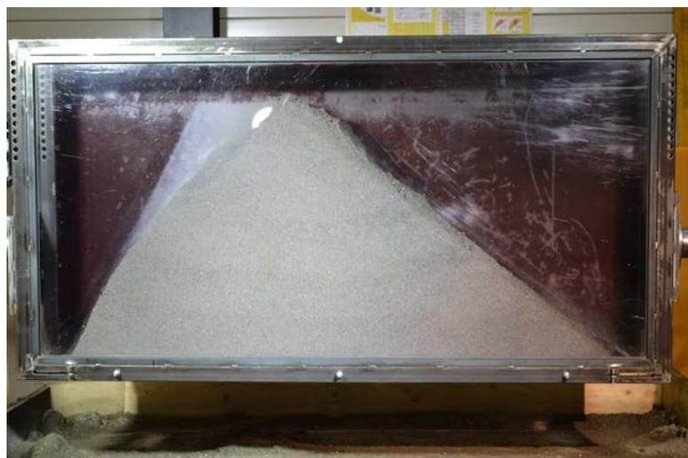
**Abb. 3.55** Versuch St-2145-A-01-2: Bei dem 2. Impakt bleibt der Stahlzylinder St im Dammkörper stecken.
