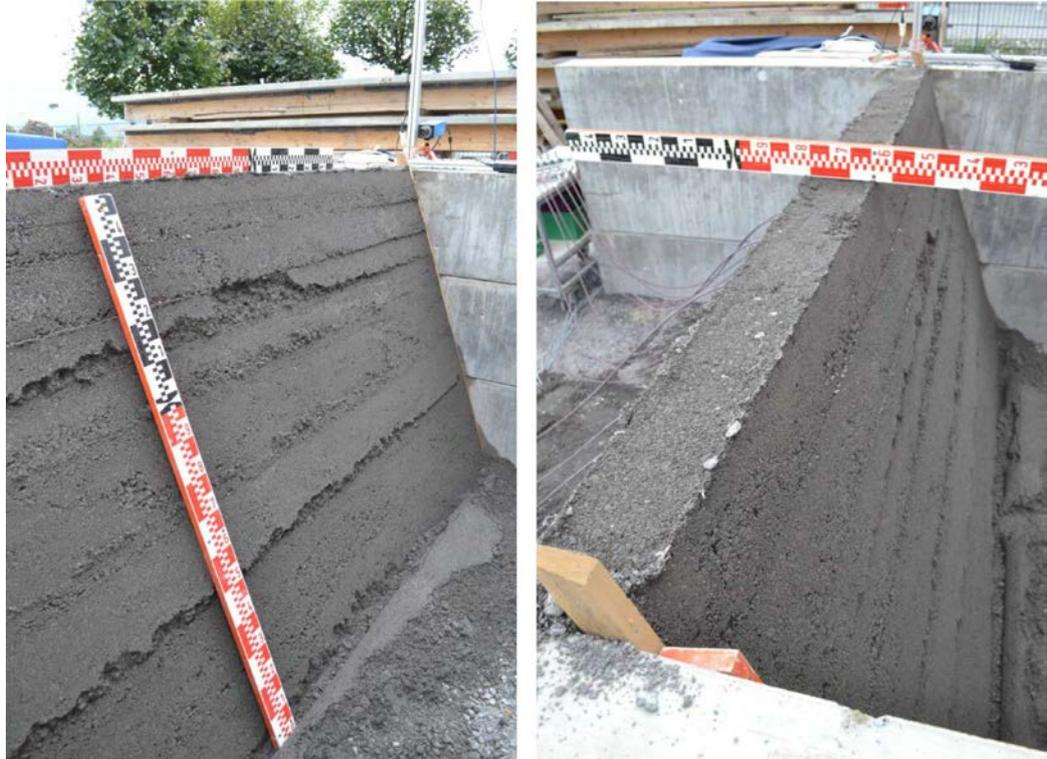
**Abb. 4.46** Versuch *impakt\_09*: Fertig gestellter Versuchsdamm mit einer  $69^\circ$ -Böschung auf der „Bergseite“ vor dem Impaktversuch.
