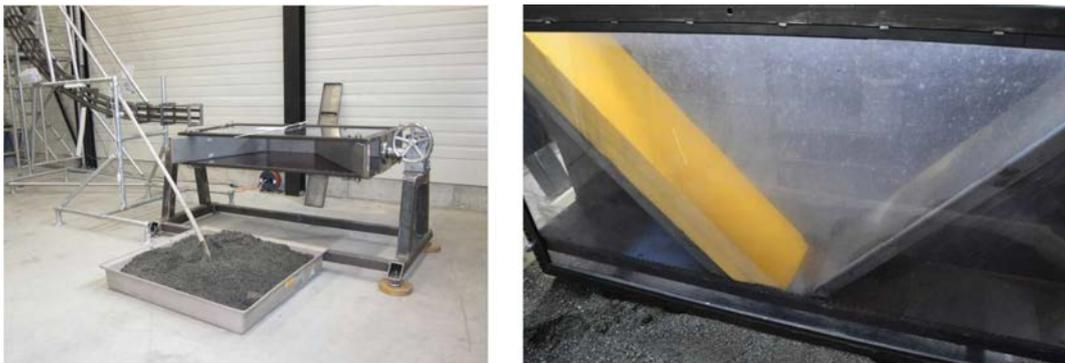
**Abb. 3.12** Links: Horizontal ausgerichteter Versuchskasten mit bereits eingebrachten Blechen für die Böschungsneigung, rechts: Auf den Kopf gestellter Versuchskasten mit einer doppelten Einlage um eine Kronenstärke des Typs D zu erzeugen.
