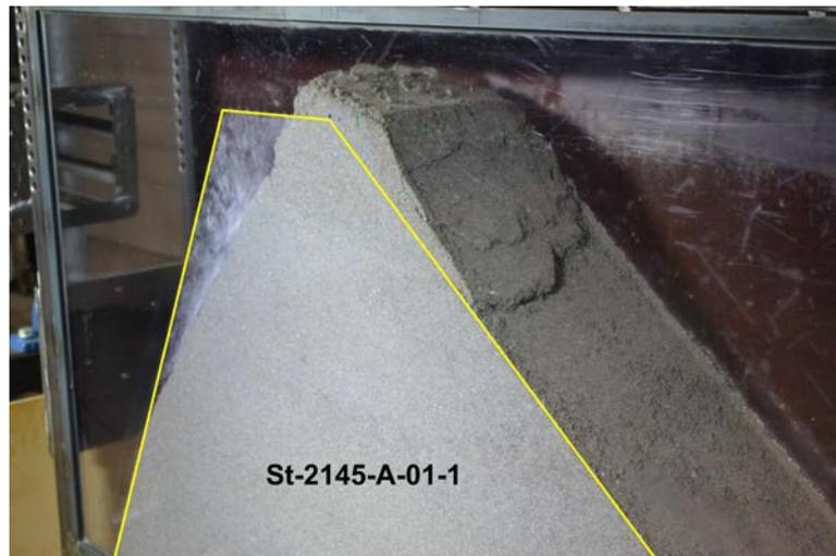
**Abb. 3.53** Versuch St-2145-A-01-1: Umriss des Damms vor dem Impakt zum Vergleich zum Damm nach dem Impakt und den stattgefundenen Materialumlagerungen.
