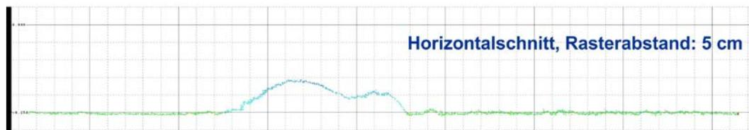
**Abb. 4.17** Versuch *impakt\_02*: Ansicht der durch den Block in den Damm geschlagenen Hohlform (oben) und Horizontalschnitt aus den Messungen mit dem 3D-Scanner (unten). Die maximale Tiefe gemäss der Scanner-Auswertung beträgt ca. 10 cm
