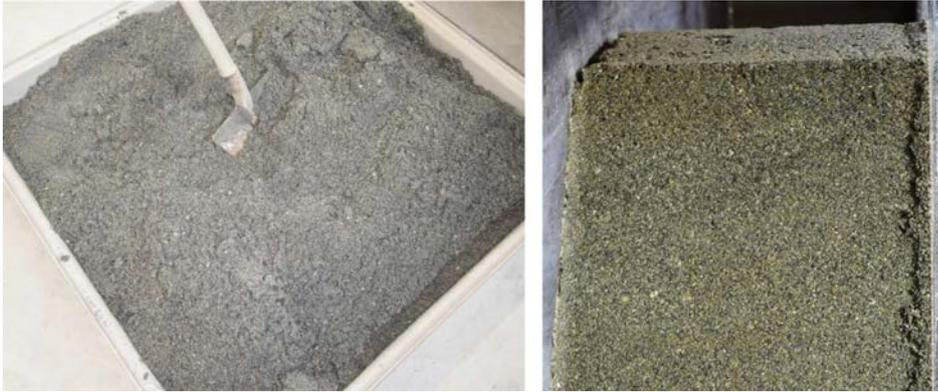
**Abb. 3.7** Versuchsboden Q2D01 beim Anmischen mit Wasser und im eingebauten Zustand.
