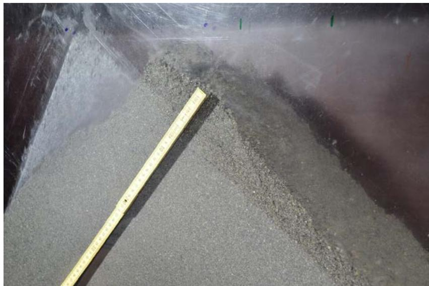
**Abb. 3.67** Versuch OKT-2145-D-01-3: Auch nach dem 3. Impakt stellt sich kein visuell erkennbarer Bruchkörper mit einer horizontalen oder einer nach unten geneigten Scherfläche ein. Deutlich erkennbar durch die Farbänderung ist das durch den Block aufgeworfene Material.
