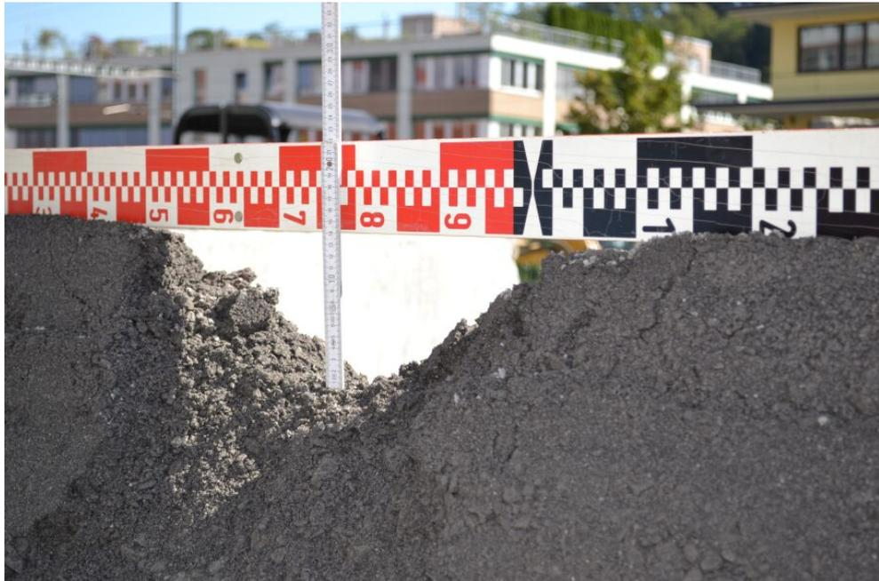
**Abb. 4.41** Versuch *impakt\_08*: Durchschlagene Dammkrone, Ansicht „Bergseite“.
