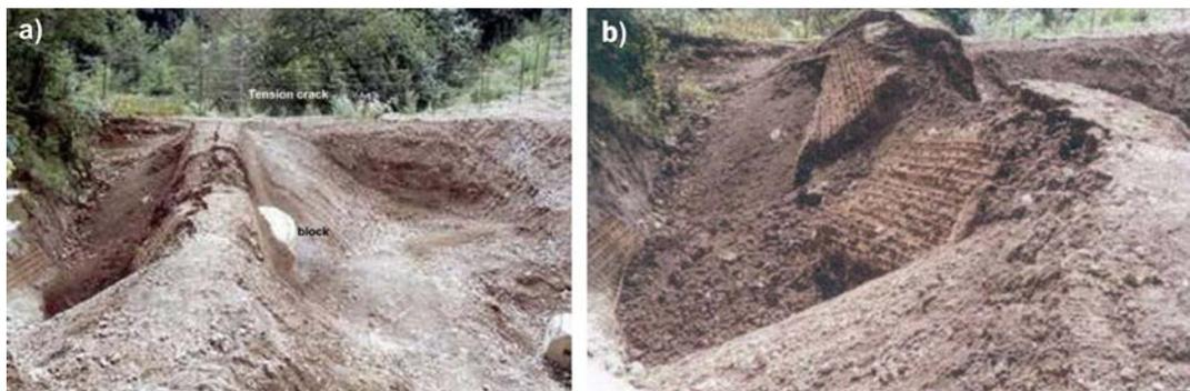
**Abb. 2.19** Versuche von Peila et al. an einem nicht bewehrten Schutzdamm: a) nach dem Impakt weist die Dammkrone über einen weiten Bereich einen Zugriss auf, b) im Bereich des Impakts ist der Schutzdamm vollständig zerstört, rechts und links der geschlagenen Bresche ist das Material in Form eines Böschungsversagens abgerutscht [53].
