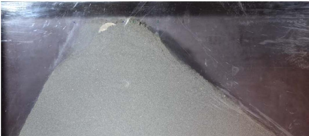
**Abb. 3.57** Versuch St-2145-A-11: Endzustand nach dem 1. Impakt, der Block bleibt im Damm stecken. Die konvex geformte Rissstruktur ist hier nicht mehr zu erkennen.
