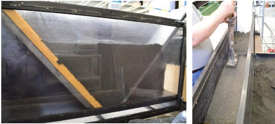
**Abb. 3.13** *Lagenweiser Einbau und Verdichten des Versuchsboden Q2D01.*
