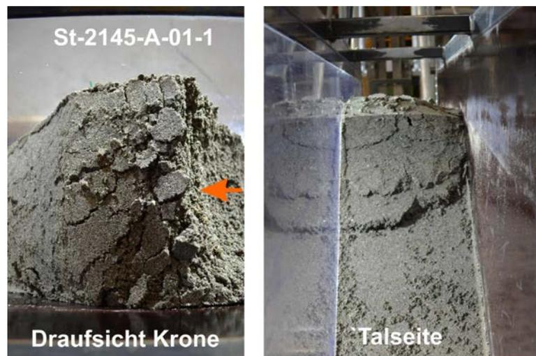
**Abb. 3.54** Versuch St-2145-A-01-1: Dammkrone nach dem 1. Impakt und den stattgefundenen Materialumlagerungen.
