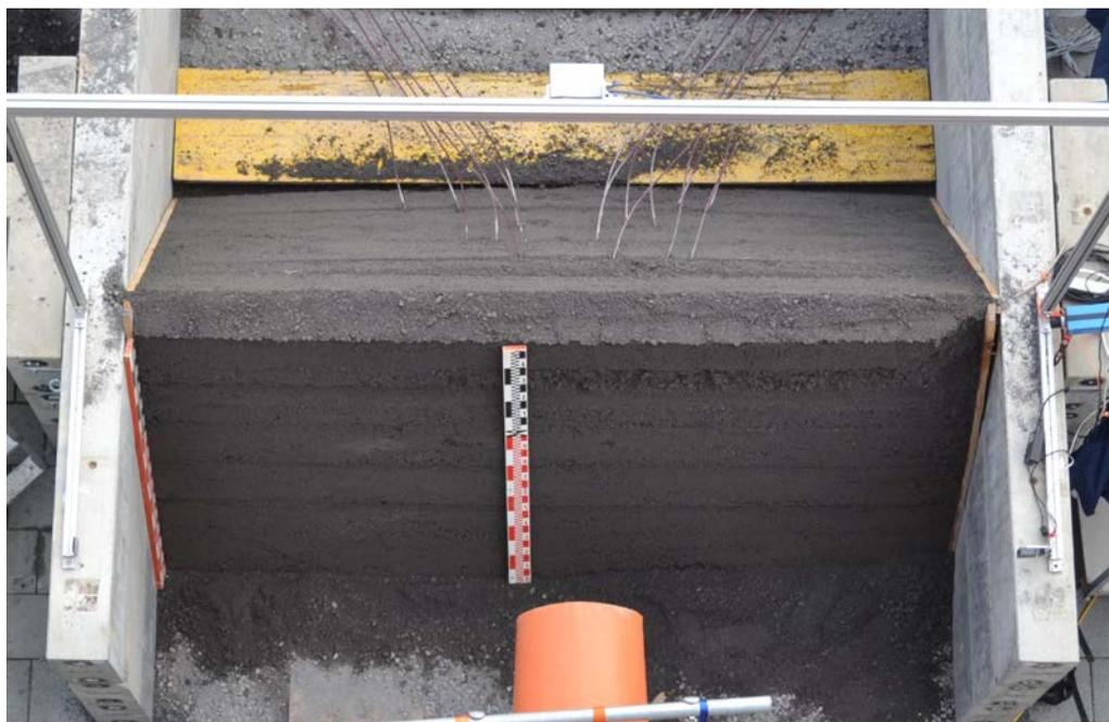
**Abb. 4.49** Versuch *impakt\_10*: Fertig gestellter Damm aus der Vogelperspektive.
