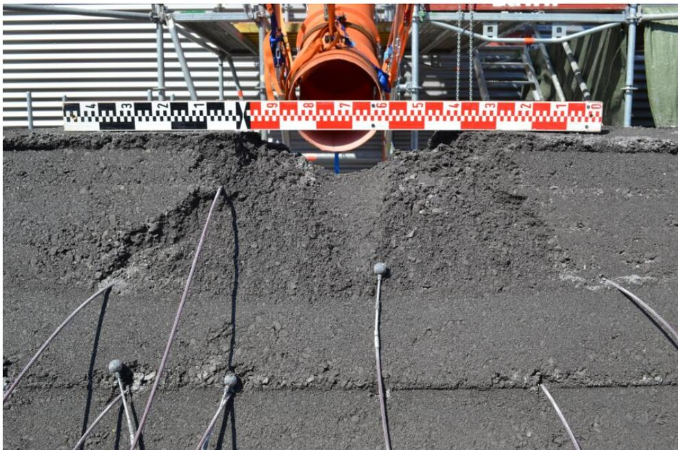
**Abb. 4.42** Versuch *impakt\_08*: Durchschlagene Dammkrone, Ansicht „Talseite“.
