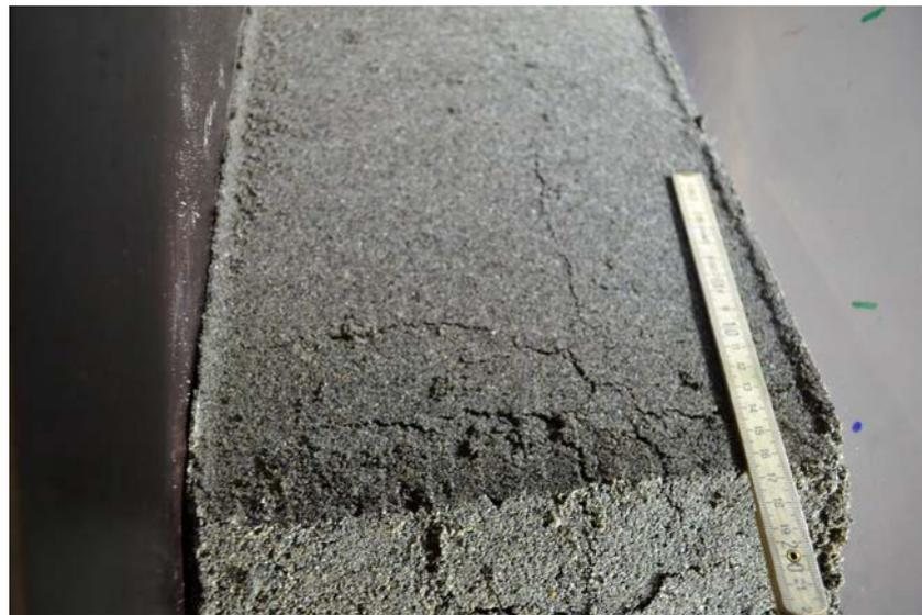
**Abb. 3.64** Versuch OKT-2145-A-01: Rissbildung auf der dem Impakt abgewandten Seite nach dem 3. Impakt..
