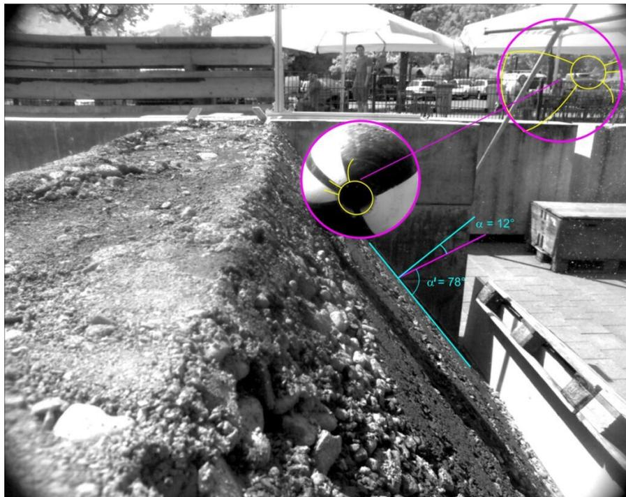
**Abb. 4.12** Beispiel für die Ermittlung der Blockposition und Blockrotation,  $\alpha$  ist der Impact- oder Auftreffwinkel.
