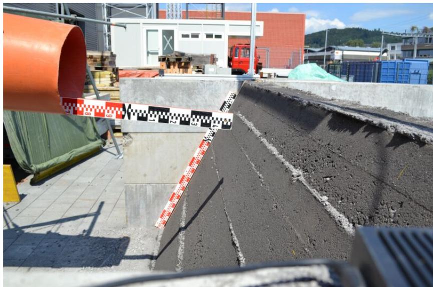
**Abb. 4.36** Ausgeschalteter Damm beim Versuch *impakt\_07*. Neigung des Fallrohrs gegenüber der Horizontalen:  $6^\circ$
