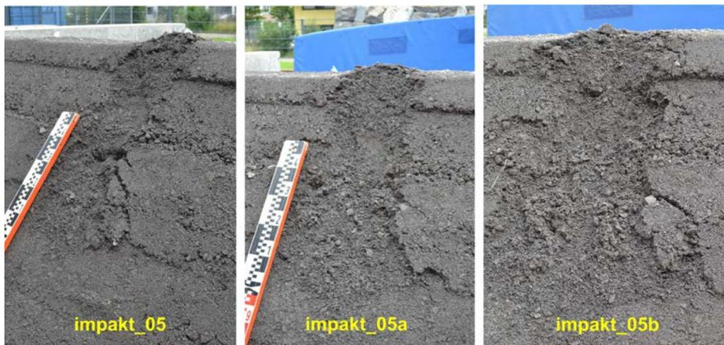
**Abb. 4.27** Vergleich des Aufschlagpunktes auf der „Bergseite“ nach den Versuchen *impakt\_05*, *impakt\_05a* und *impakt\_05b*.
