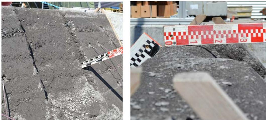
**Abb. 4.30** Versuch *impakt\_05c*: Um einen Durchschlag beim Impact zu erzwingen wurde die „Talseite“ um ca. 12 cm abgegraben. Trotz Vorschädigung durch 3 Versuche und Abgrabung hat der Block den Damm nicht durchgeschlagen sondern auch bei diesem Versuch übersprungen.
