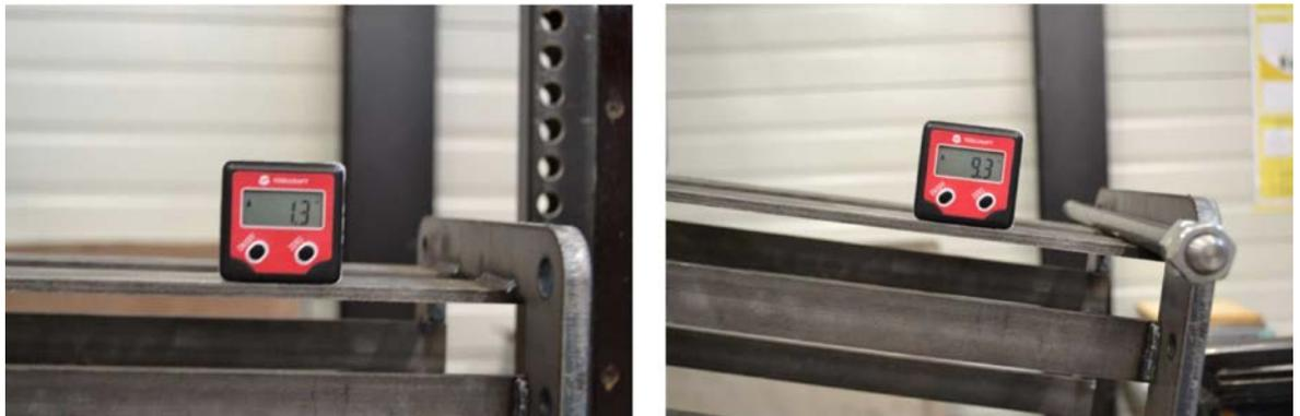
**Abb. 3.3** Neigung des Fallrohrs am Ausgang: Einstellung 01: 1.3°, Einstellung 11: 9.3°.
