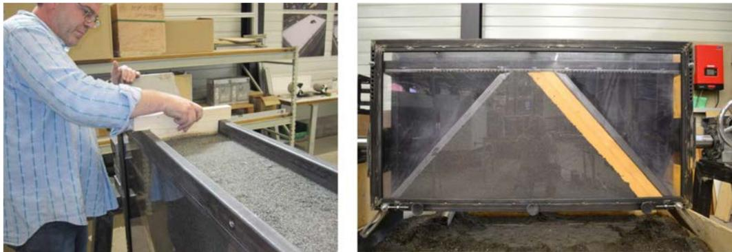
**Abb. 3.14** *Links: Ebenen des Versuchsbodens vor Einbringen des Bodenblechs, rechts: Fertig eingebaute Damm vor dem Ziehen der Bleche und Ausbau der Einlagen.*
