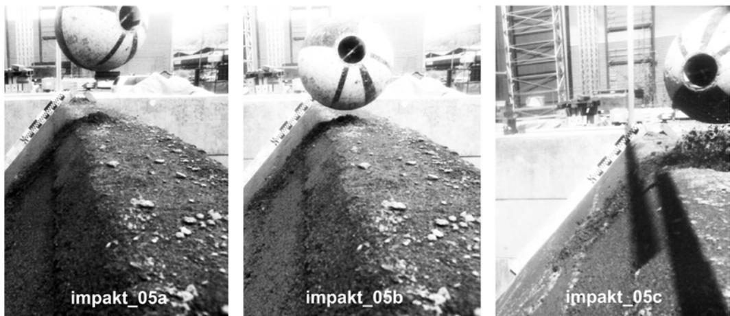
**Abb. 4.26** Sprunghöhen bei den Versuchen *impakt\_05a*, *impakt\_05b* und *impakt\_05c* im Vergleich. Das aufgelockerte Dammmaterial aus den vorangegangenen Versuchen reduziert zum Teil die Sprunghöhen.
