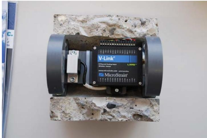
**Abb. 3.2** Beschleunigungssensor und Mini-Datenlogger in einem Hohlzylinder, der während der Versuchsdurchführung zerbrochen ist.
