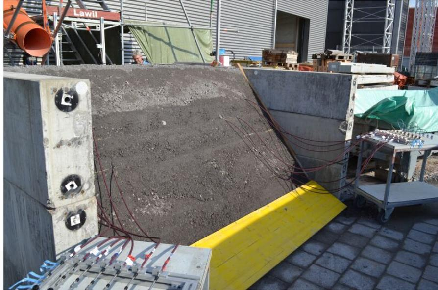
**Abb. 4.9** Fertig gestellter Versuchsdamm mit 16 eingebauten push-pull-Kabeln auf vier Messebenen.
