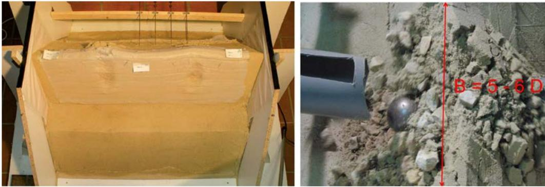
**Abb. 2.20** Versuchsstand von Hofmann und Mölk zur Untersuchung des Impakts auf Modelldämme (links) und Impakt der Stahlkugel auf einen Modelldamm mit Steinschichtung (rechts) [36].
