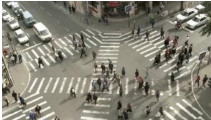
Abb. 7 Links: Schild in Toronto. Die Fussgänger werden mit einem Schild auf die Möglichkeit der Diagonalquerung aufmerksam gemacht (Quelle: www.torontolife.com ) Rechts: Pedestrian Scramble in Jerusalem. (Quelle: Rapp Trans AG)
