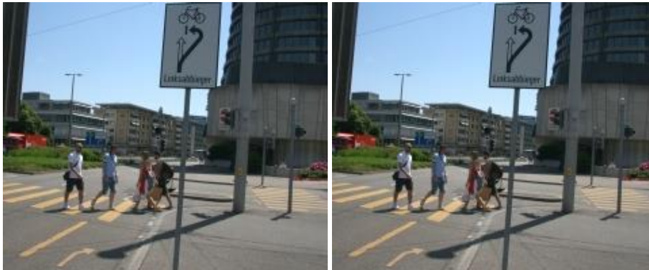
Abb. 20 Indirektes Linksabbiegen in Basel (Ecke Nauenstrasse / Aeschengraben) (Quelle: Rapp Trans AG)
