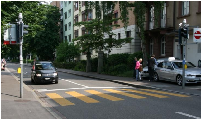
Abb. 12 An der Ecke Gempen- / Dornacherstrasse in Basel wird die Grünphase in Abhängigkeit des Fussgängeraufkommens verlängert (Quelle: Rapp Trans AG)
