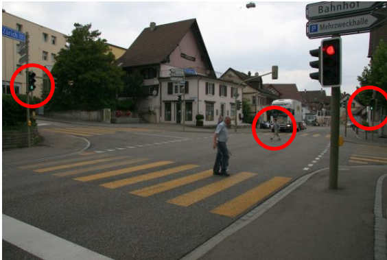
Abb. 6 An der Kreuzung Wehntaler- / Bahnhofstrasse im Zürcherischen Dielsdorf erhalten die Fussgänger ein Rundumgrün. Wie das Foto zeigt, gibt es Passanten, die diagonal queren. (Quelle: Rapp Trans AG)
