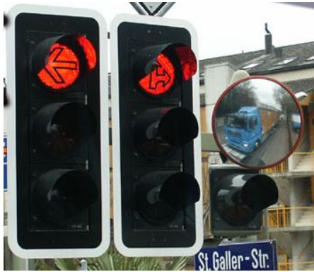
Abb. 33 Trixi-Spiegel zur besseren Sichtbarkeit der Velofahrer im toten Winkel (Quelle: http://www.atelierhasler.ch/ )
