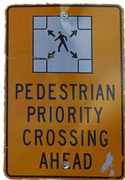
Abb. 7 Links: Schild in Toronto. Die Fussgänger werden mit einem Schild auf die Möglichkeit der Diagonalquerung aufmerksam gemacht (Quelle: www.torontolife.com ) Rechts: Pedestrian Scramble in Jerusalem. (Quelle: Rapp Trans AG)
