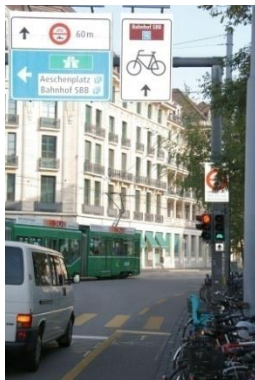
Abb. 25 Basel – die Veloampel wird nur auf Rot gestellt, wenn die querenden Fussgänger Grün haben (Quelle: Rapp Trans AG)
