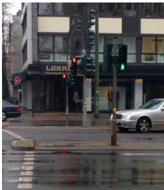
Abb. 9 Etappenweise Querung an der Berliner Allee in Düsseldorf. Eine Etappe ist Grün, zwei andere sind Rot (Quelle: Rapp Trans AG)
