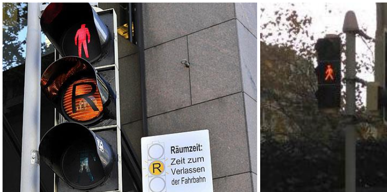
Abb. 16 Anzeige der Räumzeit durch Gelbblinken in Wien links (Quelle: http://www.krone.at/Oesterreich/Wien_testet_neue_Ampel-Anlage_mit_Raumzeit-Anzeige-Pilot-Projekt-Story-294862 ) und in Zürich rechts (Quelle: Rapp Trans AG)
