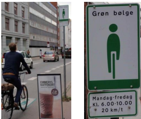
Abb. 30 Tafel „Grøn Bølge“ in Dänemark, wo zu bestimmten Tageszeiten die Lichtsignalanlagen entsprechend den Geschwindigkeiten der Velofahrer gesteuert sind (hier 20 km/h). (Quelle: Rapp Trans AG)
