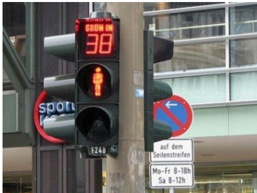
Abb. 15 Anzeige der Wartezeit mit Sekundenangabe in Hamburg (Quelle: www.chrizblog.de/ampel-mit-countdown )
