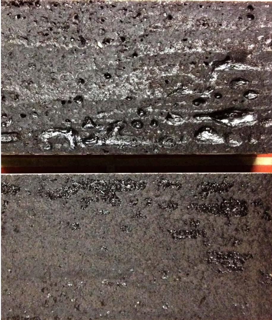
**Abb.20** Bruchbild der Prüfkörper FLK PU; der Bruch erfolgte in der Grenzfläche FLK PU zu MA (oberes Bild MA / unteres Bild FLK PU)
