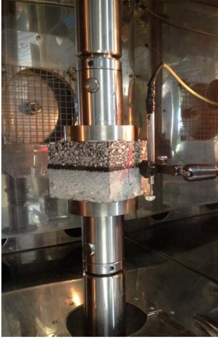
**Abb. 2** Einbau in Universalprüfmaschine
