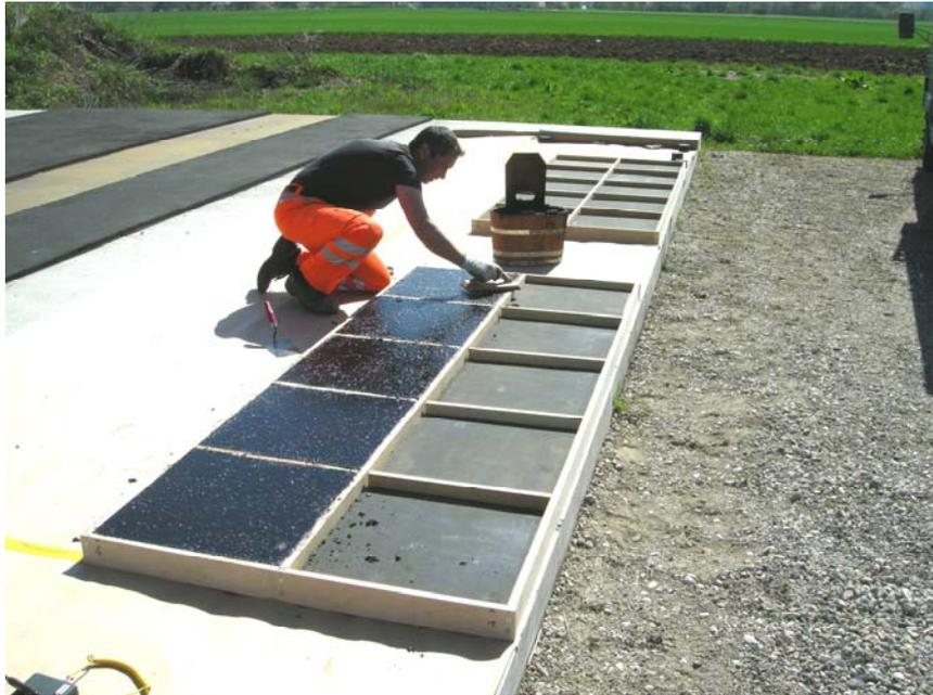
**Abb.1** Herstellung von 20 Platten 40x40 cm mit dem Aufbau PBD 2 (EP-Versiegelung / PBD SBS-modifiziert / MA 11 40 mm)
