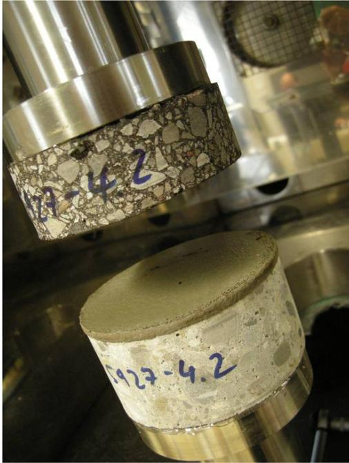
**Abb.5** Bohrkern abgebrochen nach 1 Zyklus. Schichttrennung MA-Schutzschicht zur Abdichtung FLK PU
