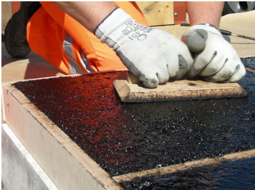
**Abb.2** Herstellung von 20 Platten 40x40 cm mit dem Aufbau PBD 2 (EP-Versiegelung / PBD SBS-modifiziert / MA 11 40 mm)
