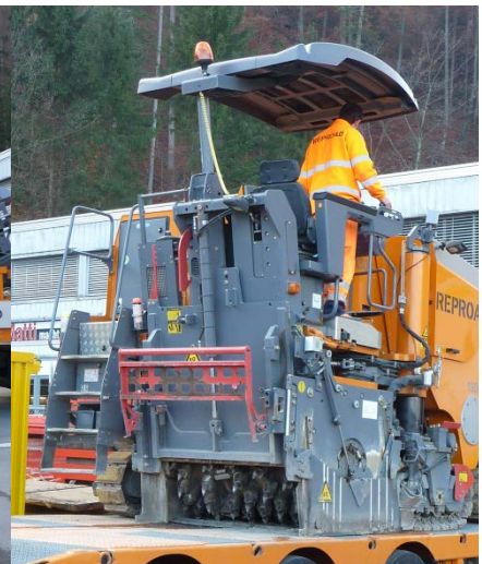
Abb. 18 Rückseite der Fräse mit Fräsdornen
