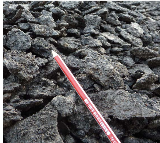
Abb. 22 Fräsmaterial RAP4u aus Tragschicht AC T 22 H
