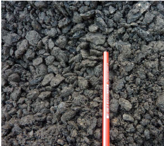
Abb. 21 Fräsmaterial RAP3u aus Deckschicht AC 11 N
