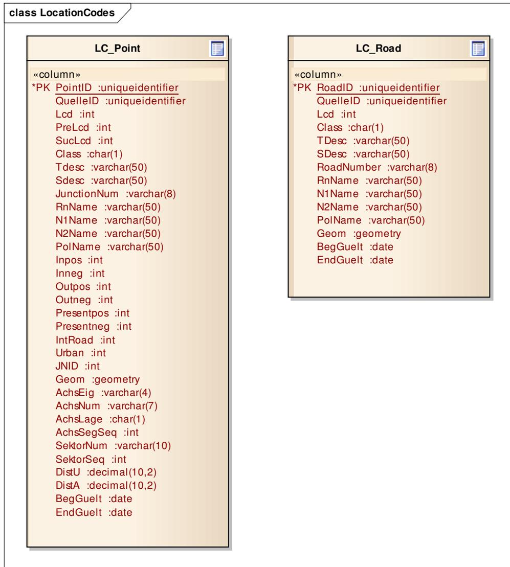
Abbildung 22: Logisches Modell TMC Location Codes für das Ausgabesystem QGIS
