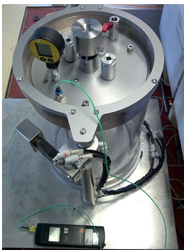
Abb. 9 Triaxzelle von oben: Druckluftzelle mit Manometer und Thermoelement. Neben der zentrierten Stange, zwei Durchgänge für die LVDT Wegsensoren.
