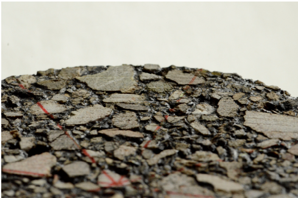
Beschichtung mit Latexmembranen; die Körner ragen heraus.
