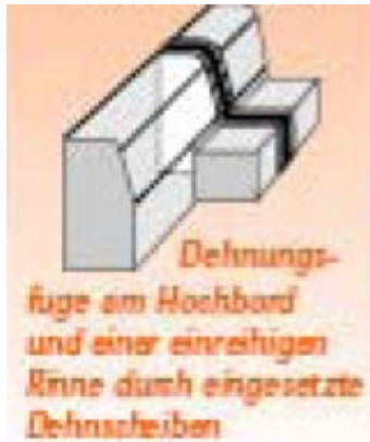
Abb. 4.33 Anordnung von Dehnungsfugen (Bild aus [13])
