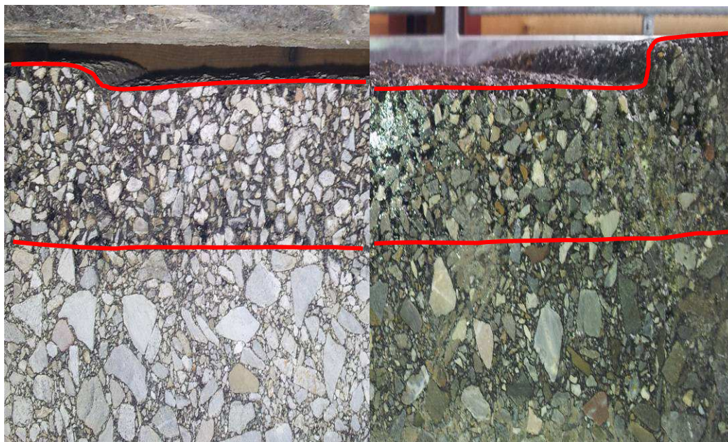
Fig. 5.53 Répartition par couches de l'orniérage pour les deux planches d'essais (gauche : Haute performance ; droite : Standard).
