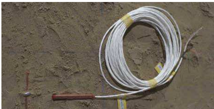
Fig. 5.44 Aperçu d'une jauge de température Pt100.
