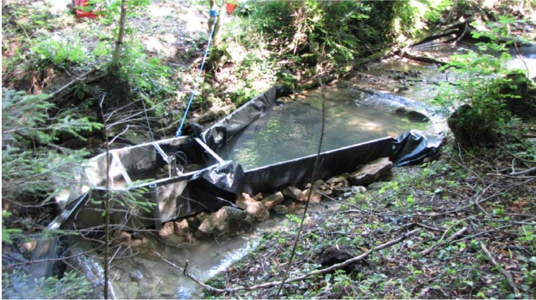
Abb. 5.13 Überfallwehr zur Messung der Abflussmenge im Leisibach (Roth, 2011).
