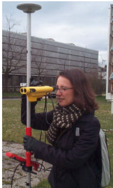
Figure 2-1 : Distance-mètre laser et récepteur GPS
