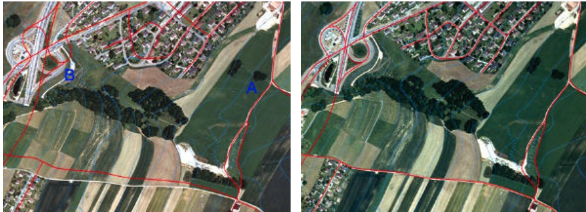
Figure 4-2 : Image non rectifiée (à gauche) et ortho-image (à droite) (Source : Office fédéral de topographie, www.swisstopo.ch )
