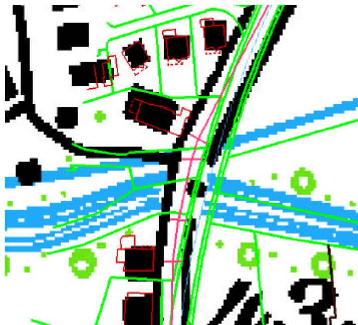
Figure 5-2 : Mensuration officielle superposée à la carte nationale (Source : Office fédéral de topographie, www.swisstopo.ch )
