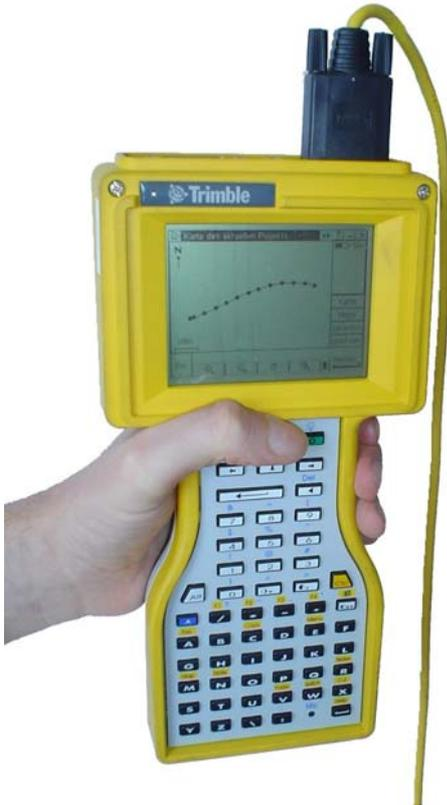
Abbildung 3.6.3: Controller mit Messlinie, Felsenauviadukt
