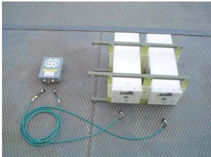
Abbildung 3.3.1: GSSI Modell 4205 Hornantennen
