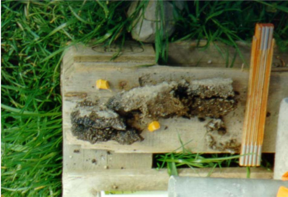
Abbildung 10.1.13: Belagsstück mit zerbröselter Schutzschicht AB11
