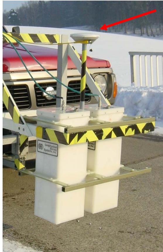
Abbildung 3.6.6: GPS-Antenne auf Fahrzeug (roter Pfeil)
