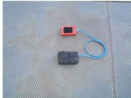
Abbildung 3.3.2: GSSI Modell 5100(1.5GHz) Antenne
