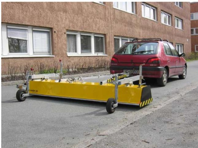
Abbildung 3.8.1: Antennenarray, Photo 3d-Radar AS, Norway
