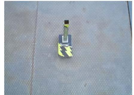
Abbildung 3.3.3: GSSI Modell 3101D (900 MHz) Antenne
