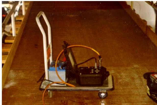
*Abbildung 5.7.2: Wägelchen mit Radargerät,
