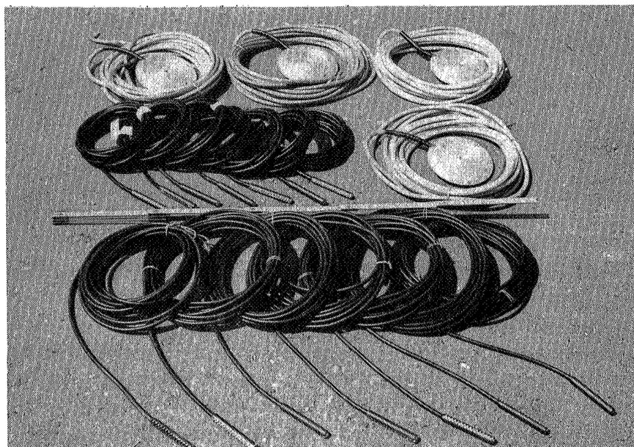
Abbildung 11: Temperaturfühler und Druckmessdosen
